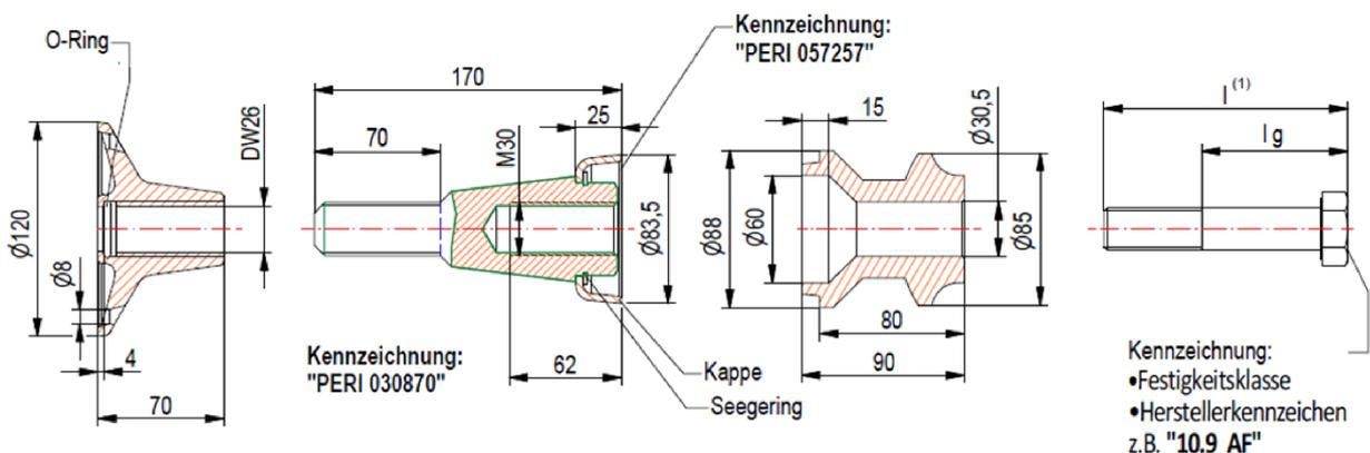
**Bild 3b: Einzelteile und Abmessungen PERI Schraubkonus M 30/DW 26**
