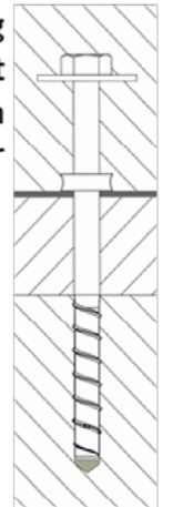
Verankerung mit einbetoniertem Verbinder
