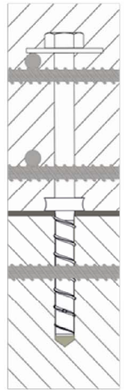
Verankerung mit einbetoniertem Verbinder
