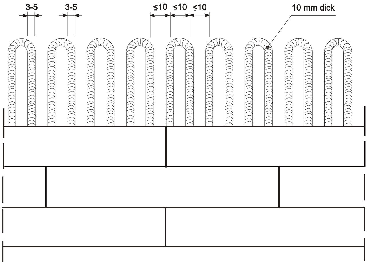
**Aufbau des WDVS mit EPS-Platten**
