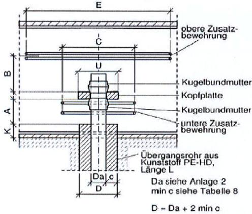
**Pfahl mit Stahl-Übergangsrohr**
