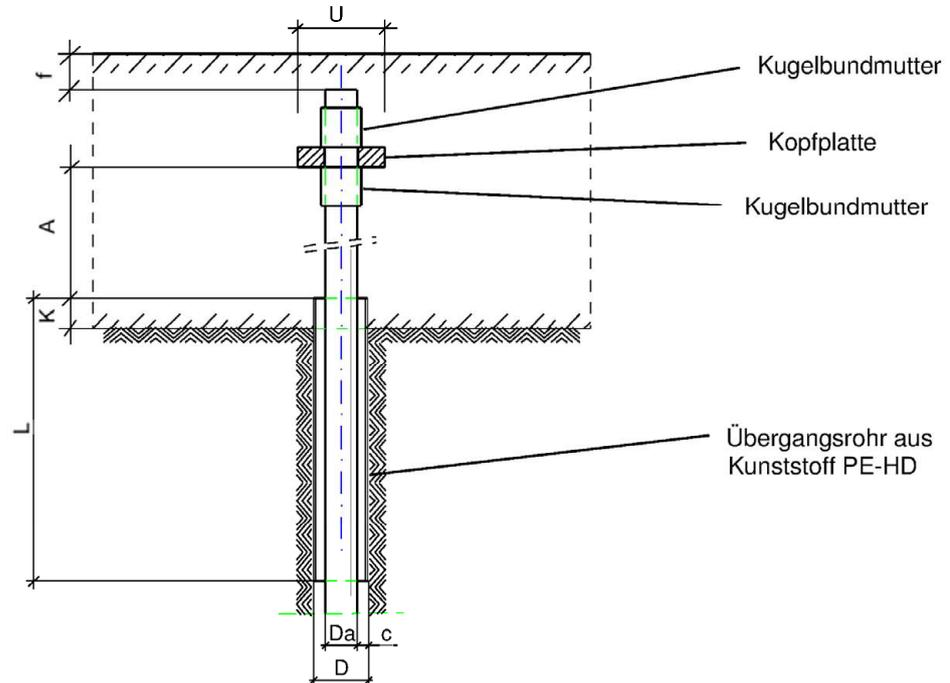
Die Weiterleitung der für die Bemessung maßgebenden Pfahlkräfte im Fundamentkörper, einschließlich des Nachweises der Teilflächenbelastung, ist nach den geltenden technischen Baubestimmungen nachzuweisen, z.B. DIN EN 1992-1-1.
