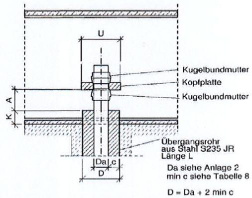
Die Mindest-Zementsteinüberdeckung min c ist im Zusammenhang mit der charakteristischen Tragfähigkeit  $R_k$  des Stahltraggliedes in Tabelle 8 der Besonderen Bestimmungen festgelegt.
