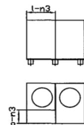
Hinweis: Anzahl der Kantungen der Seitenwände bei Bauform A bis E variiert je nach Behälterhöhe.
