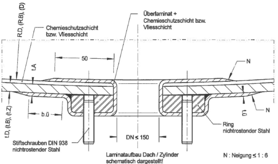
Laminataufbau Dach / Zylinder
