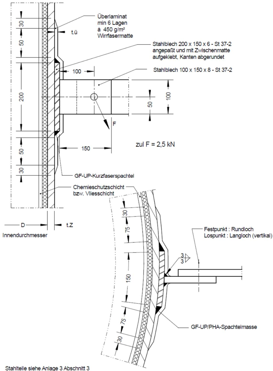
Doppelwandige Flachbodenbehälter aus GFK mit innerer Vlies- oder Chemieschutzschicht
