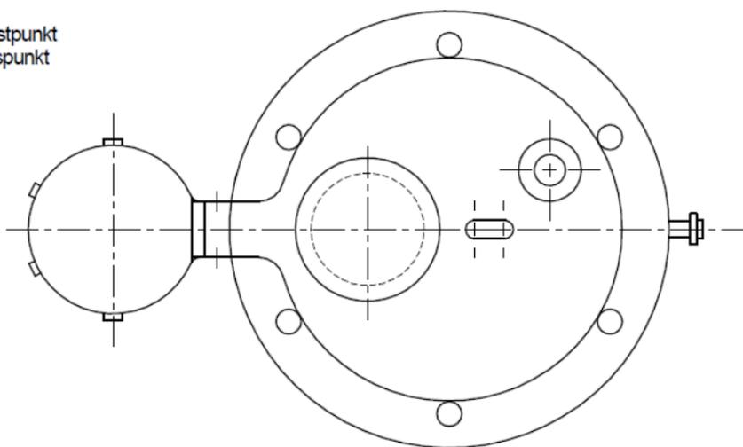
Doppelwandige Flachbodenbehälter aus GFK mit innerer Vlies- oder Chemieschutzschicht
