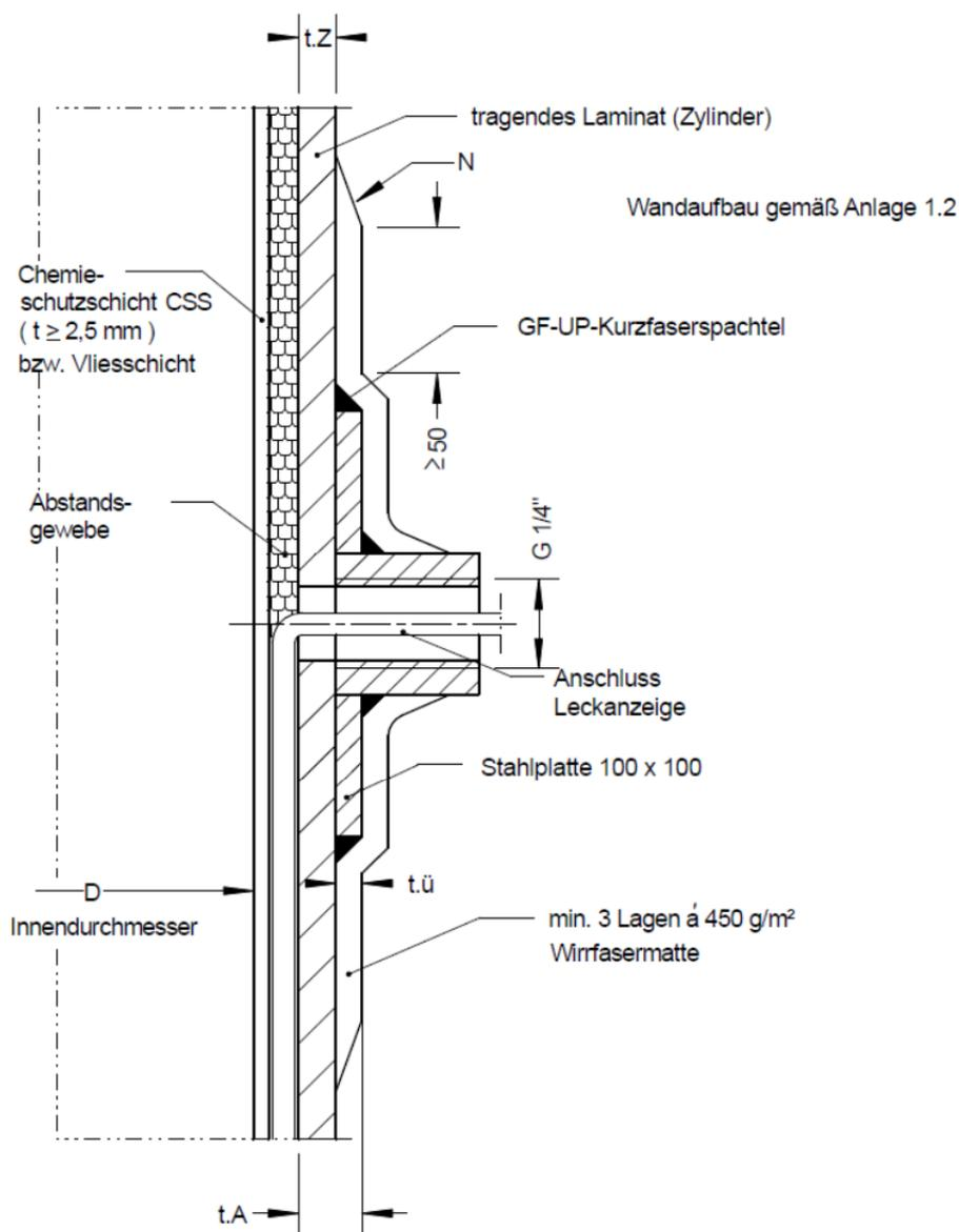
Die Darstellung zeigt den Anschluss für die Saugleitung. Die Saugleitung ist in der Behälterwand bis zum Behältertiefpunkt zu führen.
