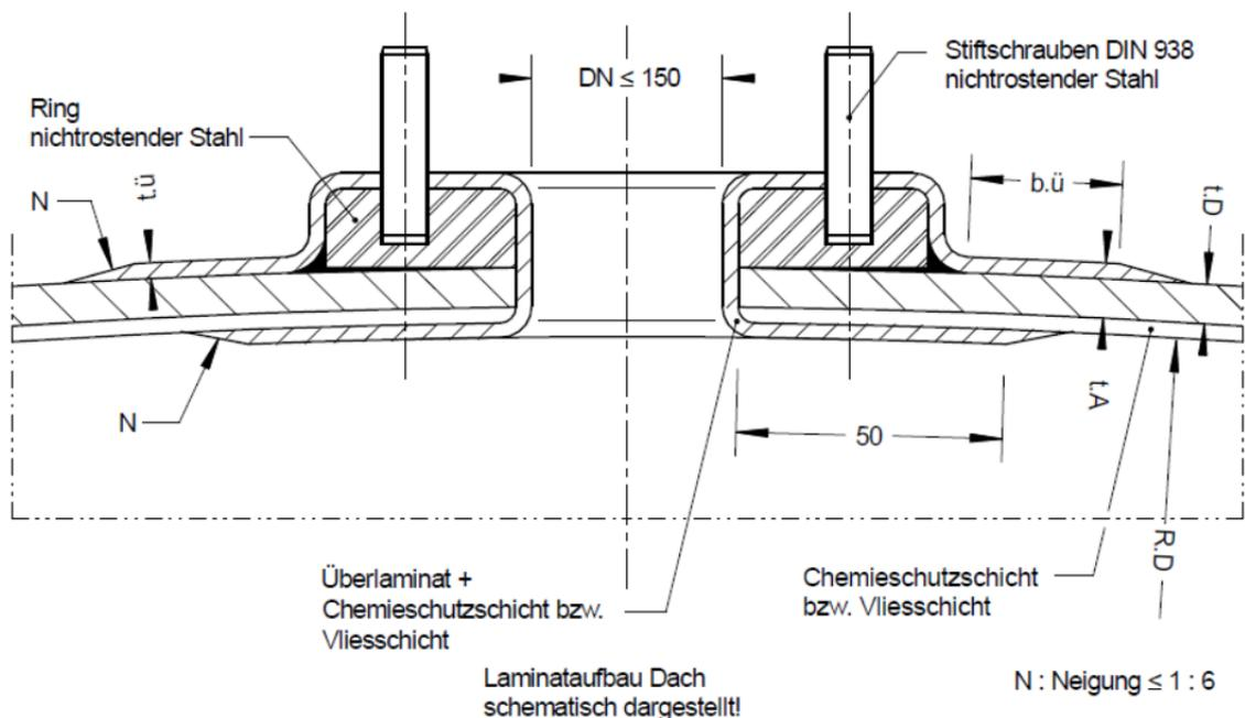
Doppelwandige Flachbodenbehälter aus GFK mit innerer Vlies- oder Chemieschutzschicht
