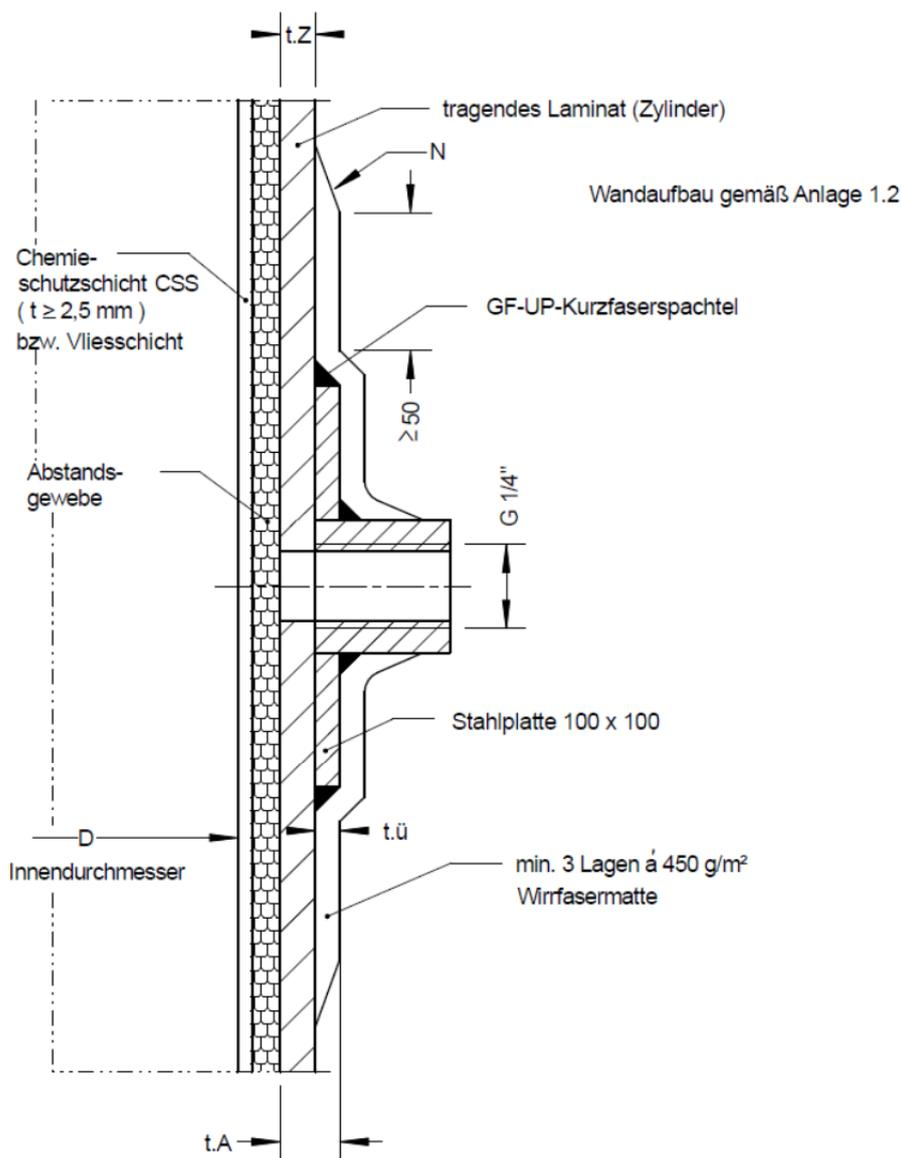
Die Darstellung zeigt den Anschluss für die Messleitung. Dieser Anschluss ist oberhalb des Flüssigkeitspiegels anzuordnen.
