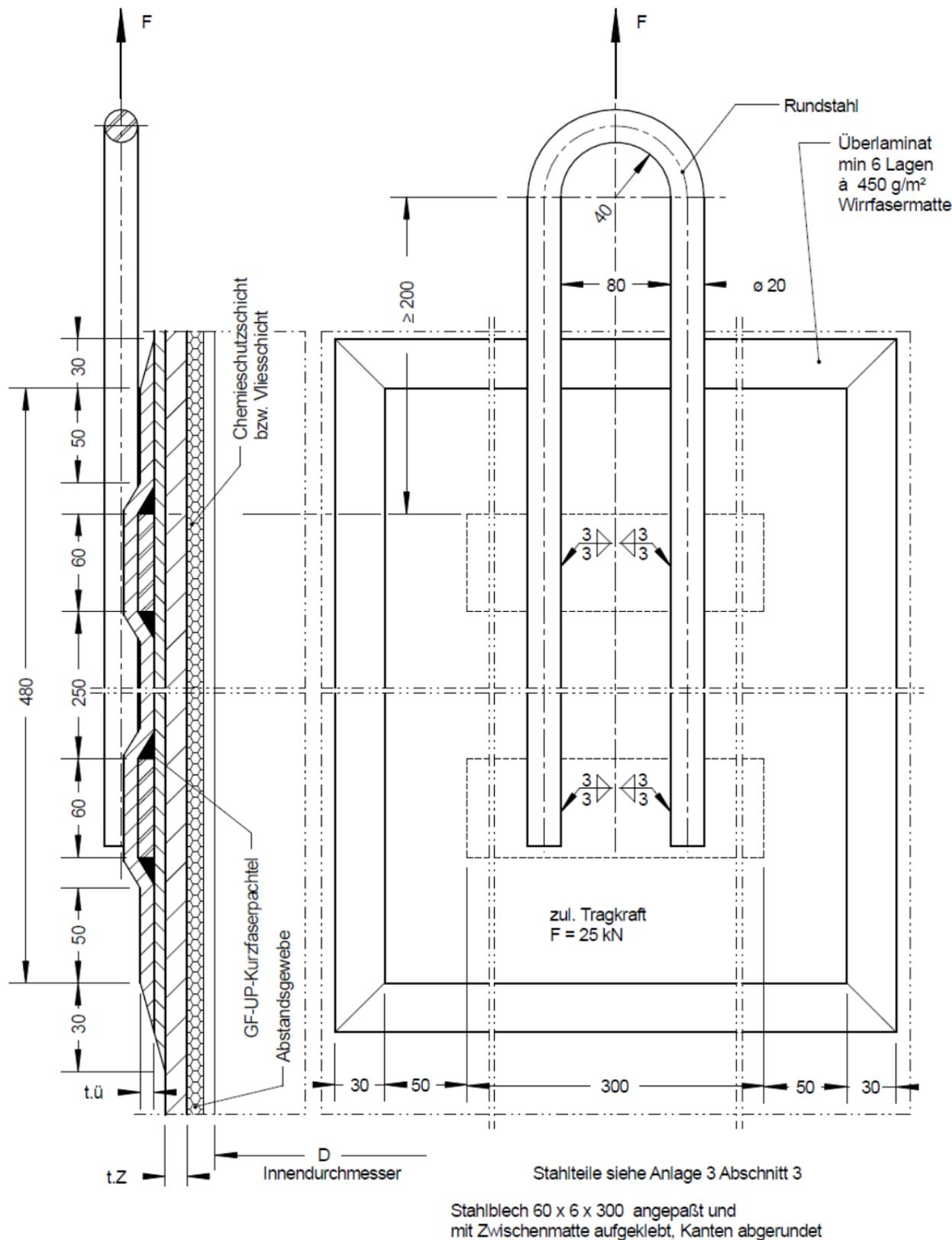
Doppelwandige Flachbodenbehälter aus GFK mit innerer Vlies- oder Chemieschutzschicht
