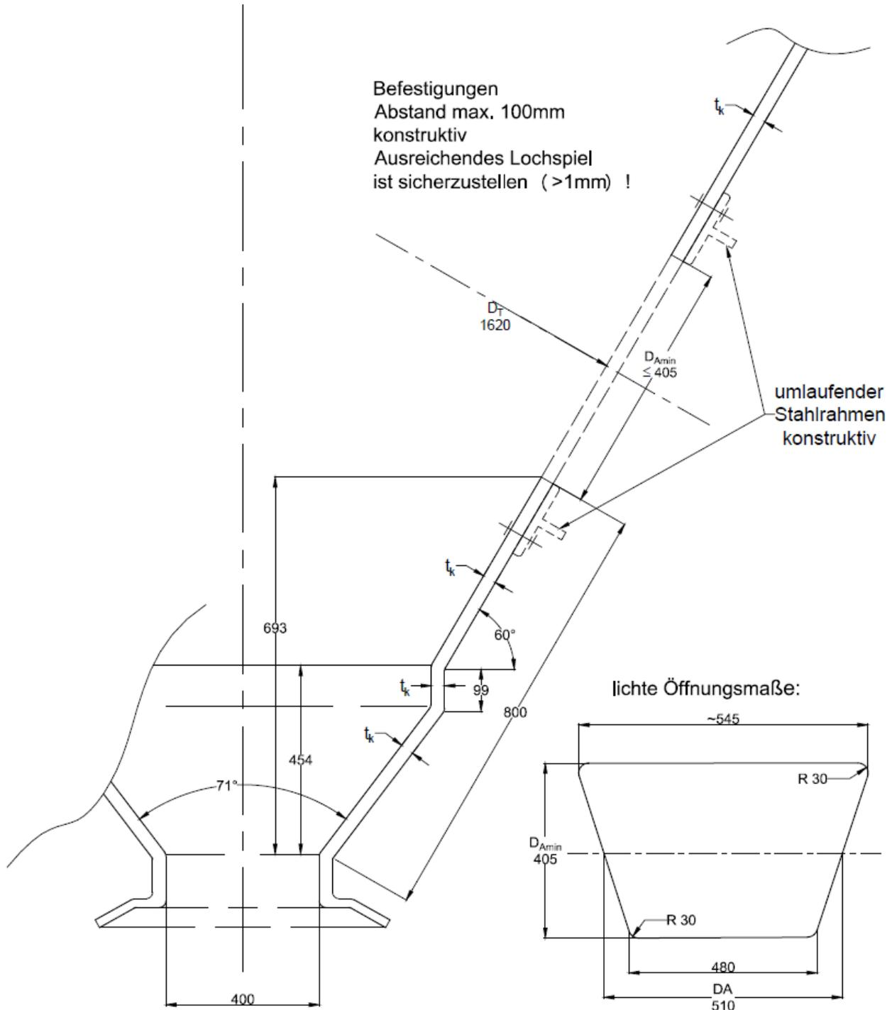
$t_k$  gemäß Hinterlegungen (Statische Nachweise/Gutachten: Silos ohne/mit Öffnungen und ohne/mit Trichterabstufung im Silotrichter)
