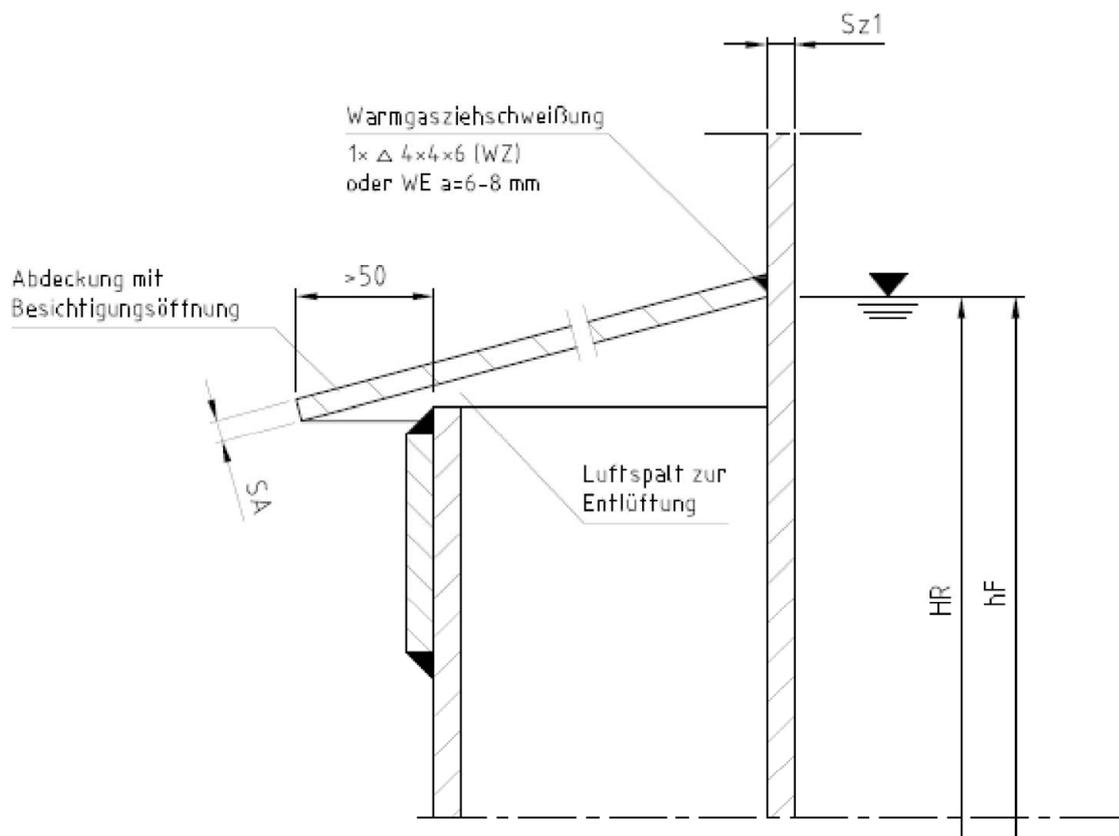
Befestigung des Regenabweisers in Abhängigkeit von hF:
