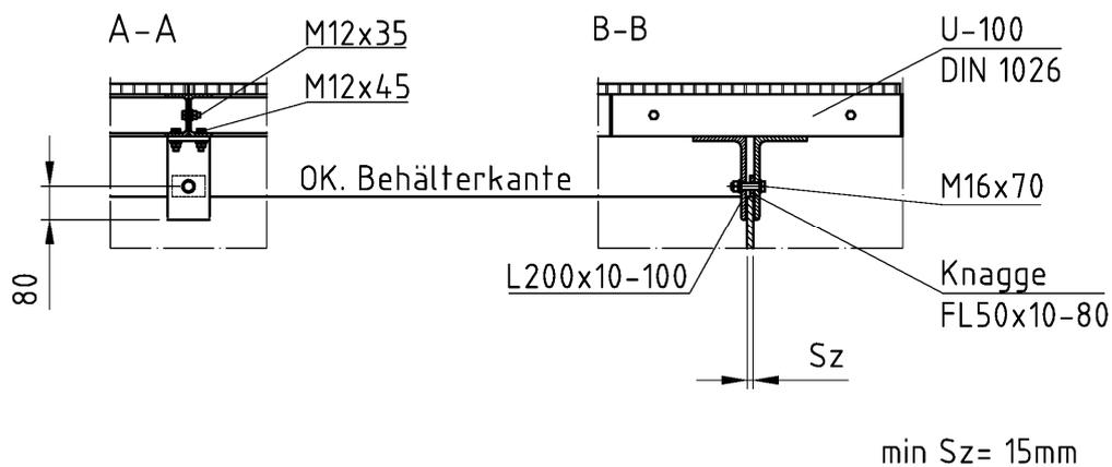
Schnitt A-A bzw. B-B gilt für alle Verbindungen am Lagerbehälter.
