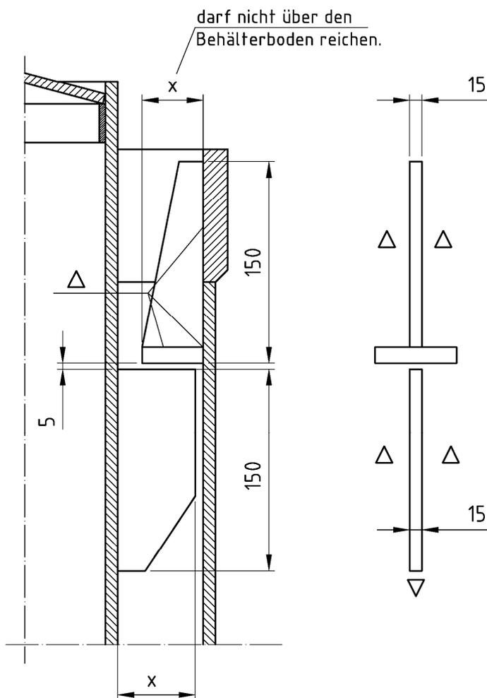
Konstruktive Sicherung des Behälters gegen Aufschwimmen
