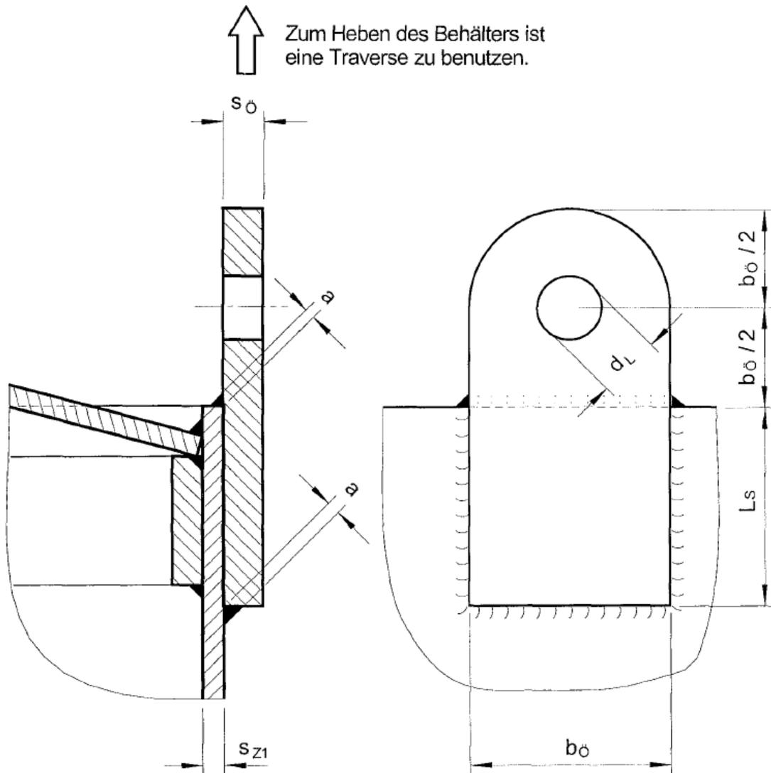
$$a \geq 0,7 \cdot s_{z1} \quad (\text{umlaufend})$$
