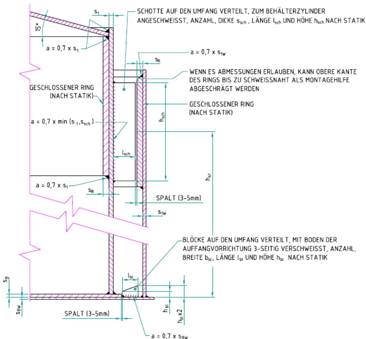
AUSFÜHRUNG DES BEHÄLTER-ZYLINDERS UND AUCH ZYLINDERS DER AUFFANGVORRICHTUNG IST IN ZWISCHALIGER BAUWEISE UND AUCH IN MEHRSCHÜSSIGER AUSFÜHRUNG GESTATTET.
