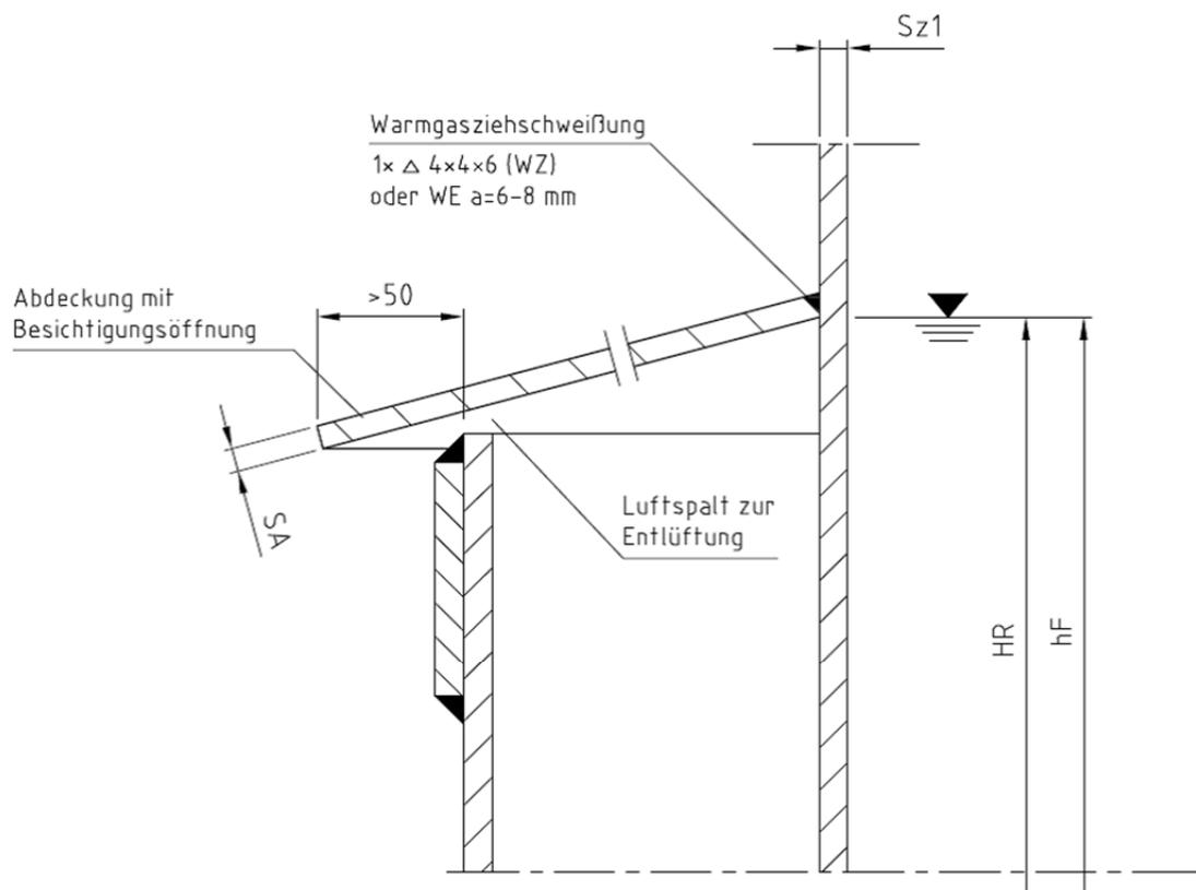
Befestigung des Regenabweisers in Abhängigkeit von hF:
