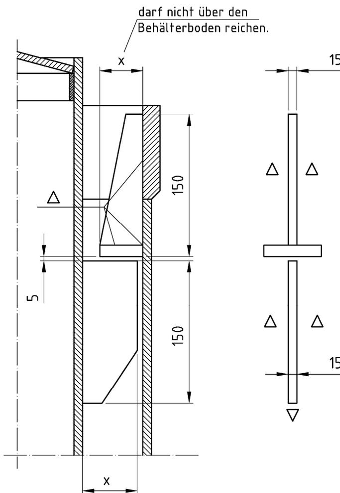
Konstruktive Sicherung des Behälters gegen Aufschwimmen
