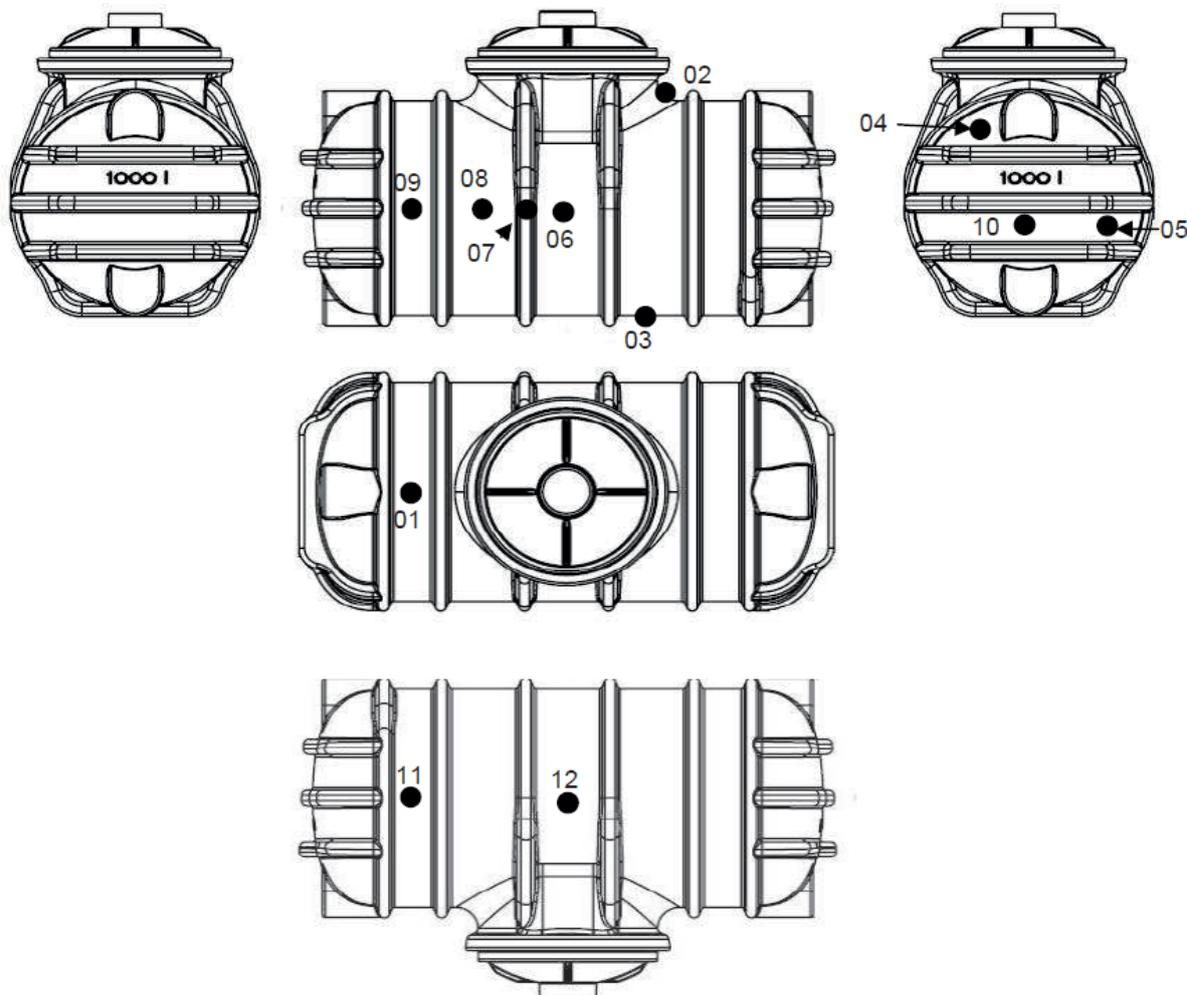
Abflusslose Sammelgrube aus Polyethylen (PE)
