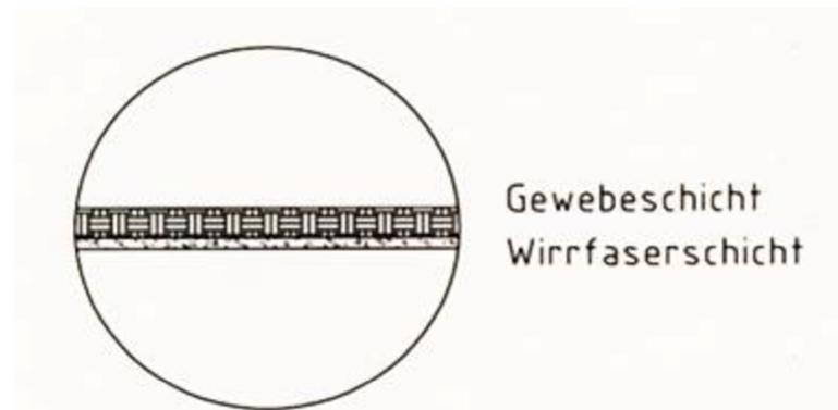
Kurzliner mit der Bezeichnung "CarboLith Spot Repair System" zur Sanierung erdverlegter schadhafter Abwasserleitungen im Nennweitenbereich von DN 100 bis DN 500
