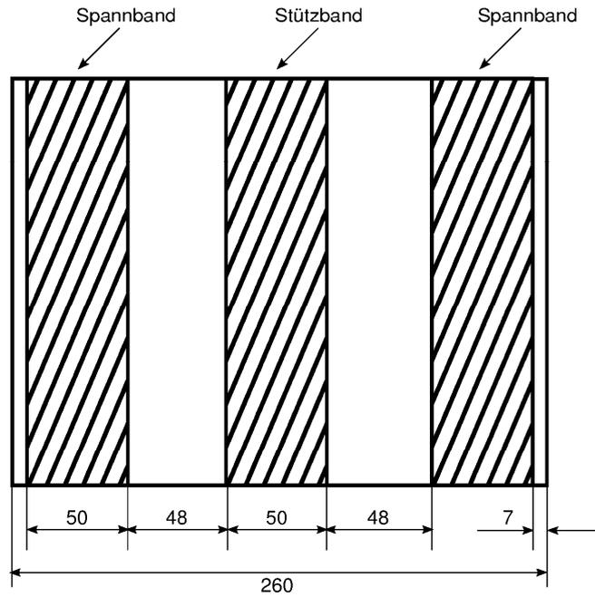
Red-Ex® Innendichtmanschette für Nennweiten DN 200 bis DN 2400
