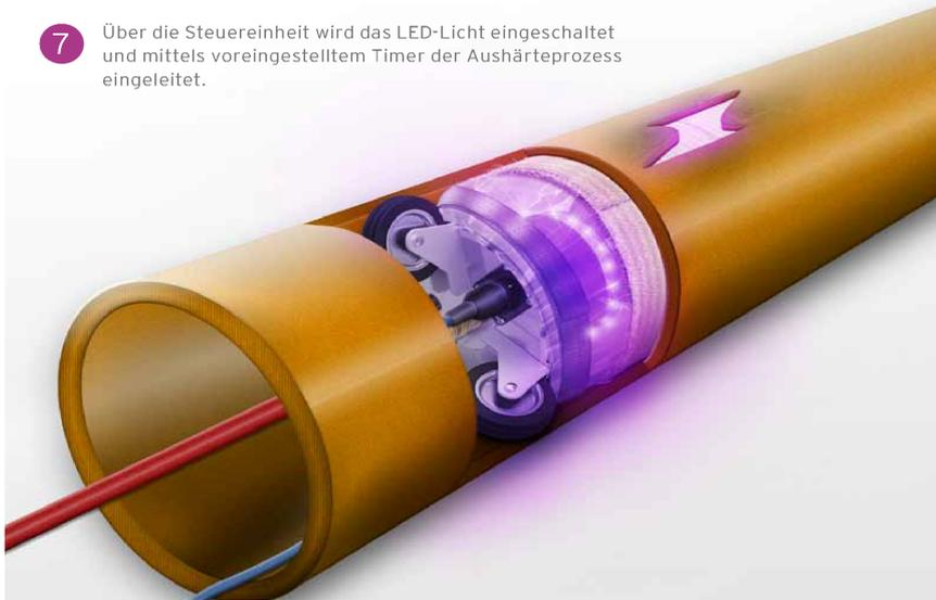
8 Nach Ablauf der Aushärtezeit schaltet sich das LED-Licht automatisch ab und der LED-Packer kann nach einer kurzen Wartezeit entlüftet und aus der Rohrleitung entfernt werden.
