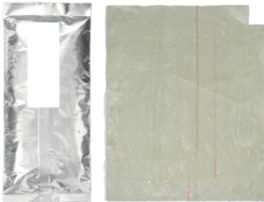
Abb.1 Prepregg verpackt / Prepreg ausgepackt/entfaltet
