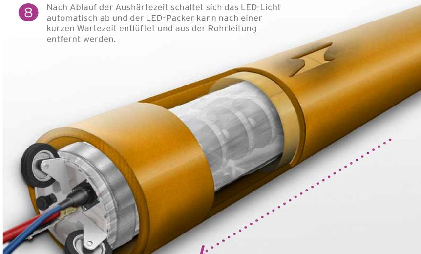
Kurzliner zur Sanierung von erdverlegten schadhaften Abwasserleitungen
