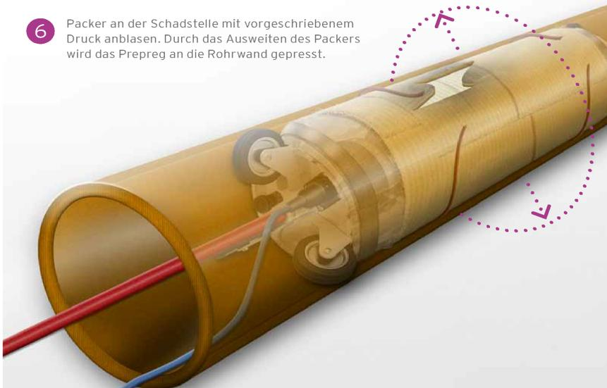
Kurzliner zur Sanierung von erdverlegten schadhaften Abwasserleitungen
