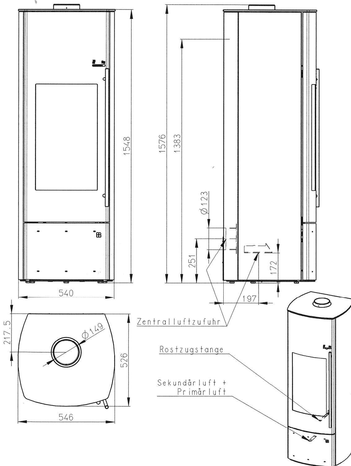
Raumluftunabhängige Feuerstätte mit Wassererwärmung mit der Bezeichnung "Nevado Aqua Compact"
