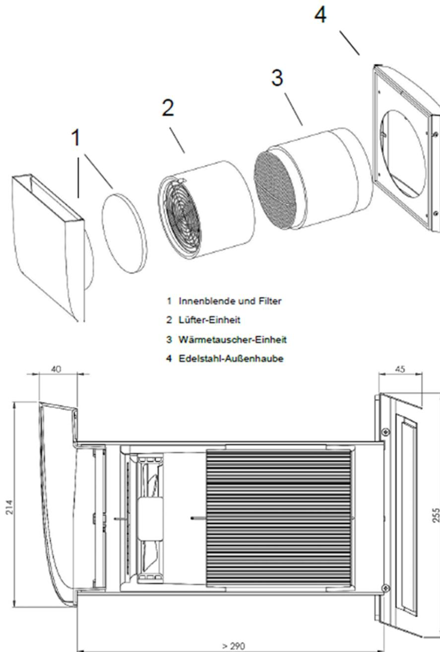
Dezentrales Wohnungslüftungssystem mit Wärmerückgewinnung vom Typ "Vitovent 050-D H20E A43"
