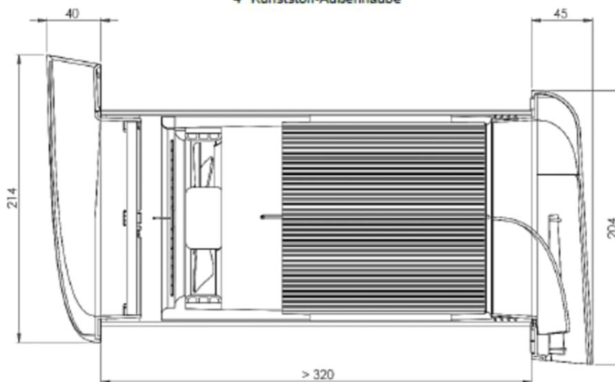
Dezentrales Wohnungslüftungssystem mit Wärmerückgewinnung vom Typ "Vitovent 050-D H20E A43"
