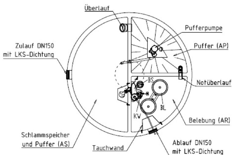
Nachrüstatz Typ LKT-BIO für den Einbau in bestehende Abwasserbehandlungsanlagen zur Herstellung von Kleinkläranlagen für 4 bis 50 EW; Ablaufklasse C
