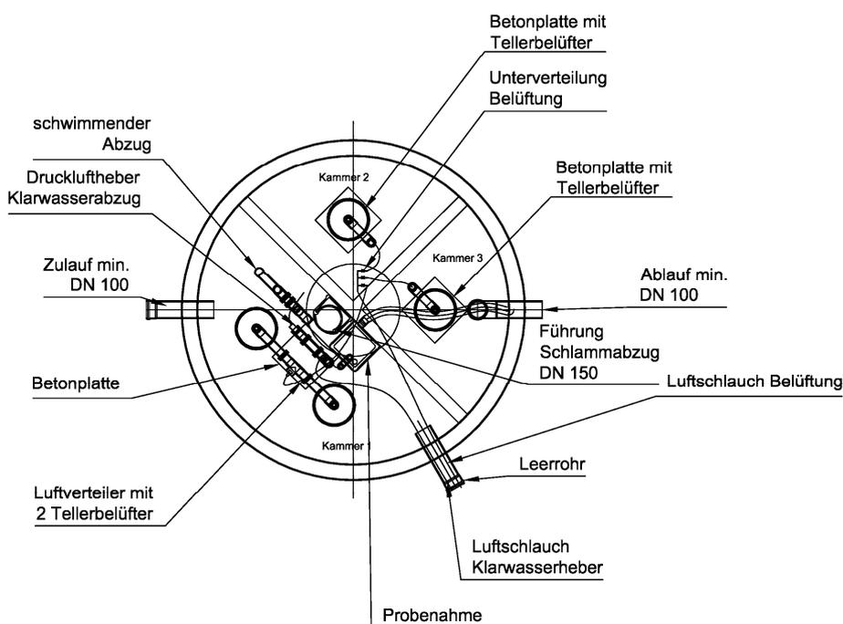
Behältervolumen gem. Bemessungstabelle, unabh. von Oberfläche und Behältergeometrie
