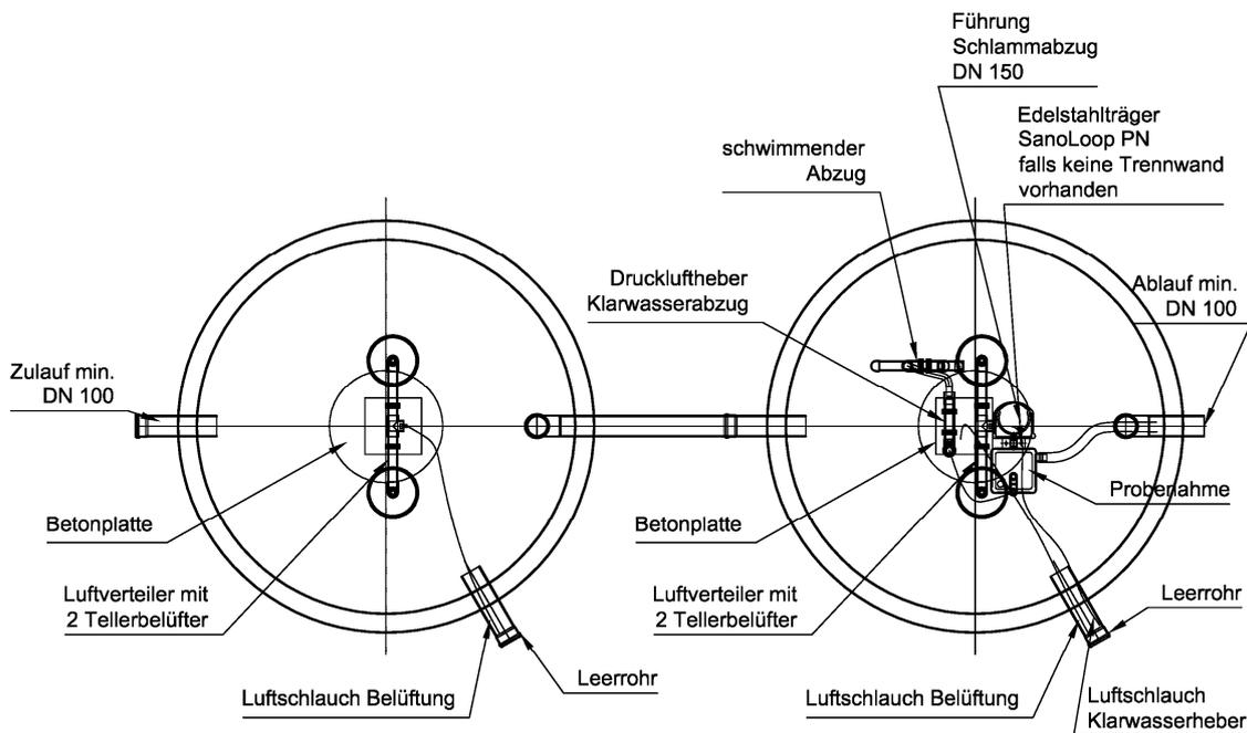
Behältervolumen gem. Bemessungstabelle, unabh. von Oberfläche und Behältergeometrie
