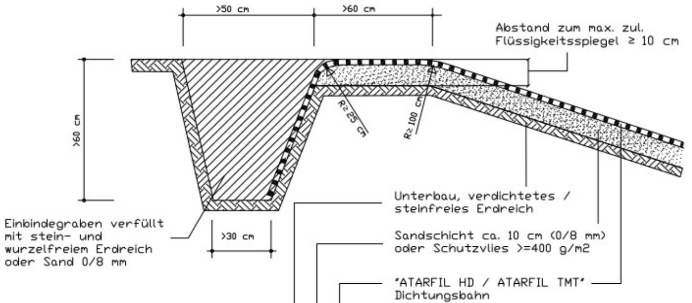
Anschluß am Böschungsfuß
