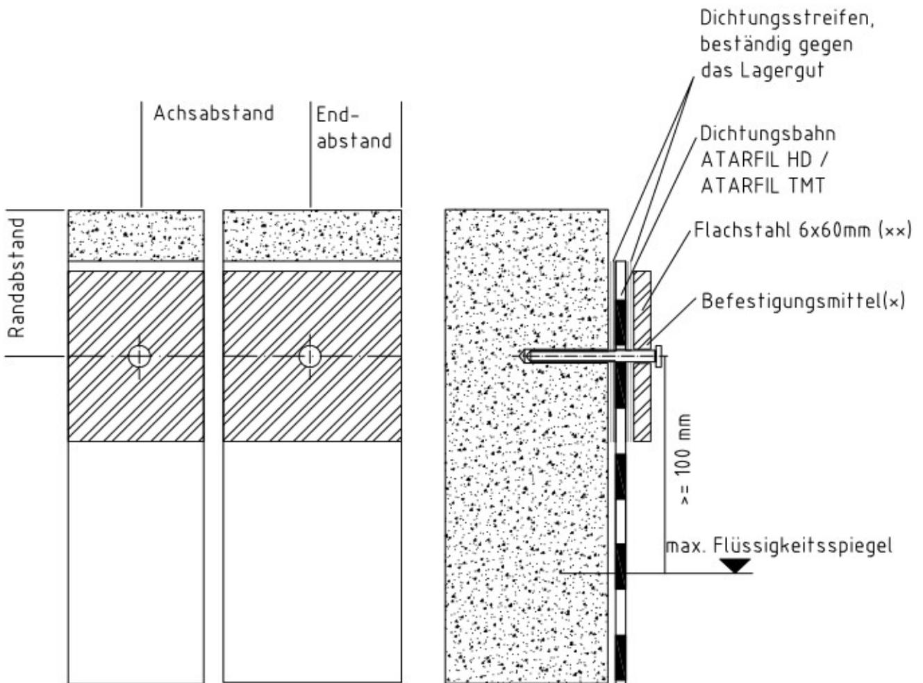
Im Ausnahmefall darf innerhalb von Gebäuden bei Bestandsbauten der Abstand zwischen der Achse des Befestigungsmittels und dem maximal zulässigen Flüssigkeitsspiegel auf 50 mm reduziert werden.
