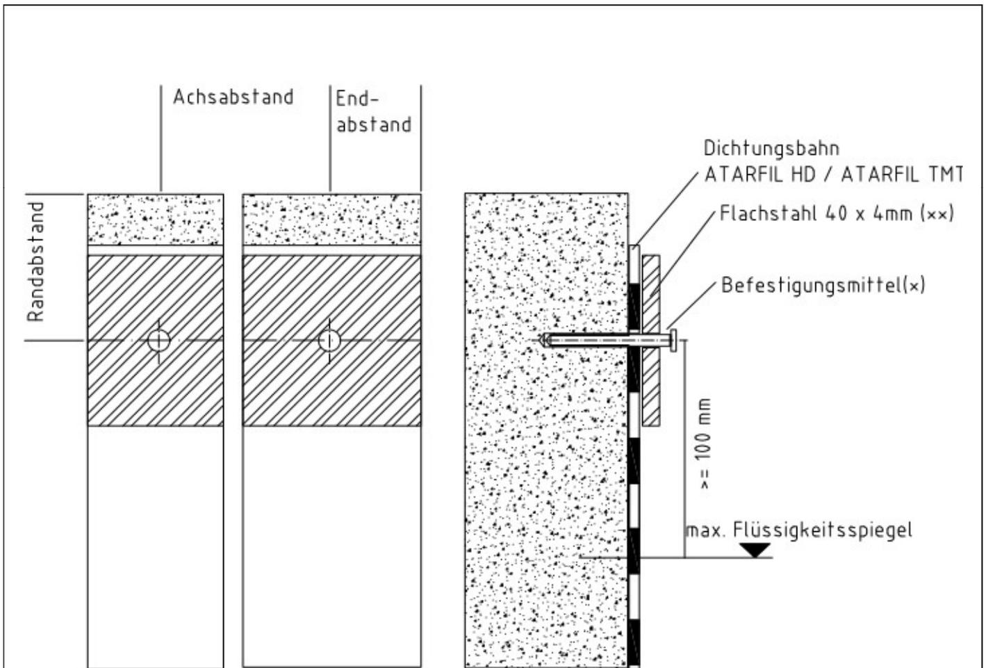
Im Ausnahmefall darf innerhalb von Gebäuden bei Bestandsbauten der Abstand zwischen der Achse des Befestigungsmittels und dem maximal zulässigen Flüssigkeitsspiegel auf 50 mm reduziert werden.
