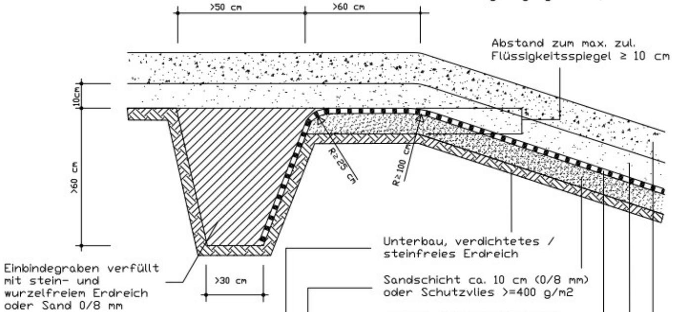
Anschluß am Böschungsfuß
