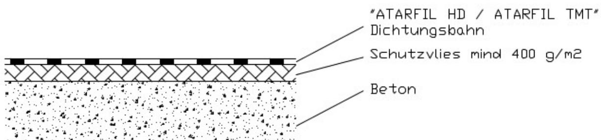
Dichtungsbahn "Atarfil HD / Atarfil TMT" als Abdichtungsmittel von Auffangwannen und -
