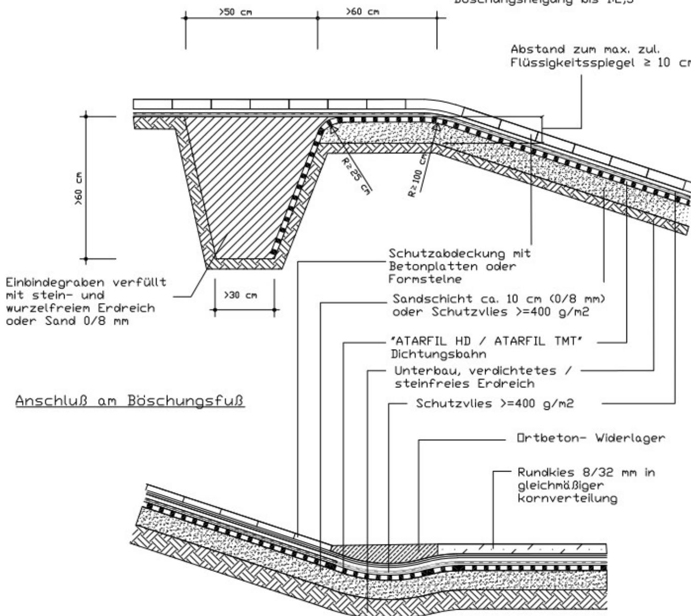
Anschluß am Böschungsfuß
