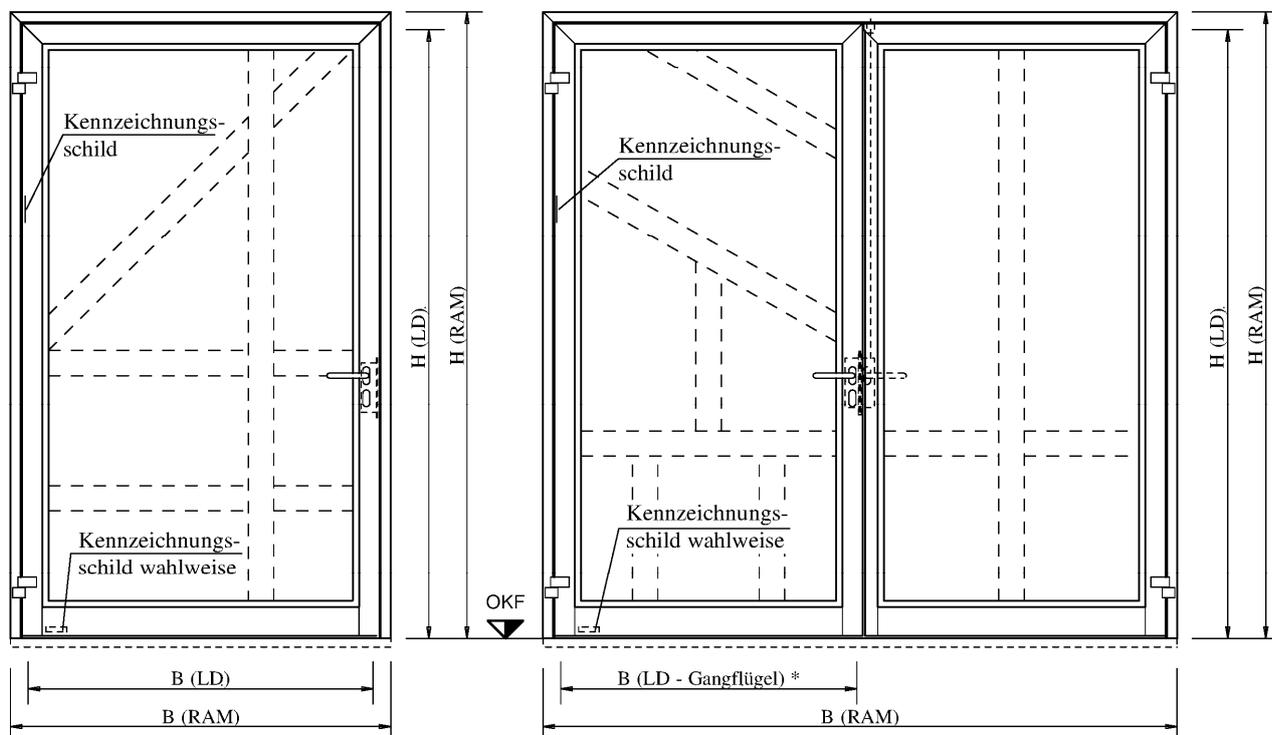
\* Bei Verwendung eines Falztreibriegels steht der LD-Gangflügel nur als Rettungsweg zur Verfügung. Dieses Maß verringert sich bei einem Öffnungswinkel von nur 90 Grad.
