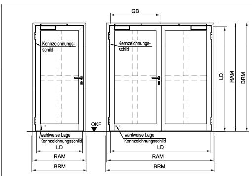
T 30-1-RS-FSA und T 30-2-RS-FSA immer mit unterer Bodendichtung ausführen und bei Wandanschluss immer beidseitig versiegeln!
