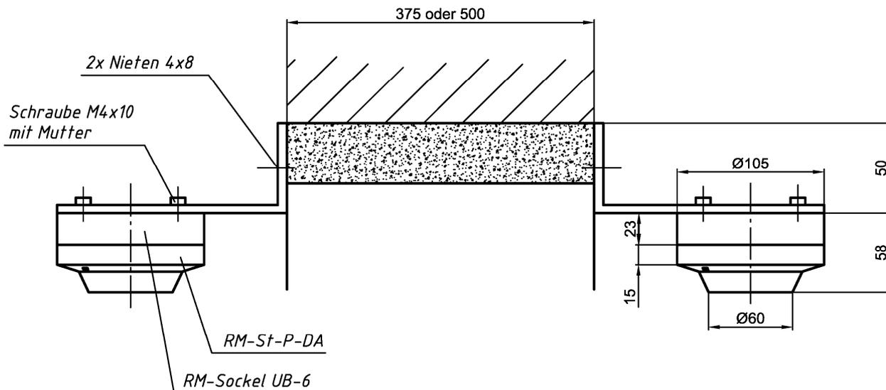
*Rauchmelder Befestigung/Einbau/Verbund mit Absperrvorrichtung "BK-EI90S"*
