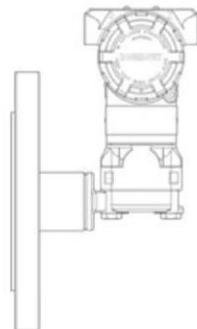
Modell 3051 mit Druckmittler Kapillaranbau (Typ PFW oder Typ F, Ausführung F)
