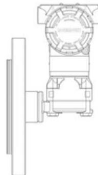
Modell 3051 mit Druckmittler Kapillaranbau (Typ RFW oder RCW-Sonderform Dichtfläche)
