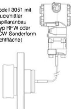
Modell 3051 mit Druckmittler Direktanbau (Typ FFW oder FCW/FUW/FVW-Sonderformen Dichtflächen, ebenso Typ F, Ausführung A)
