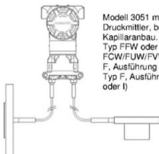
Modell 3051 mit Druckmittler Kapillaranbau (Typ EFW oder Typ F, Ausführung B, C oder D)
