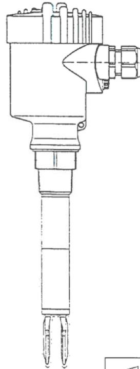
**Schema der Überfüllsicherung**
