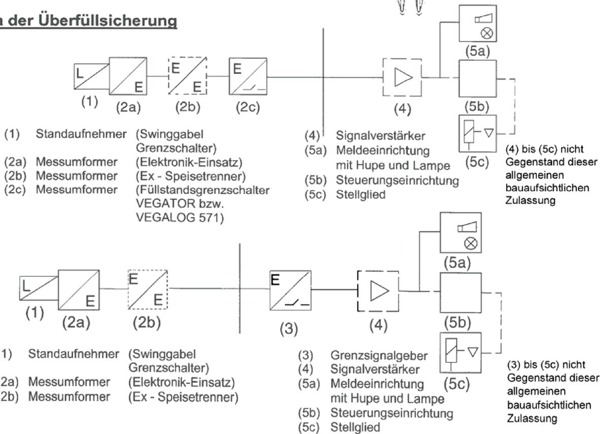
Standgrenzschalter (Schwinggabel-Grenzschalter) als Bauteil von Überfüllsicherungen
