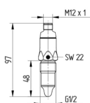
Standaufnehmer Typ "FXPL..." und "FXSL..." mit eingebautem Messumformer als Bauteile von Überfüllsicherungen
