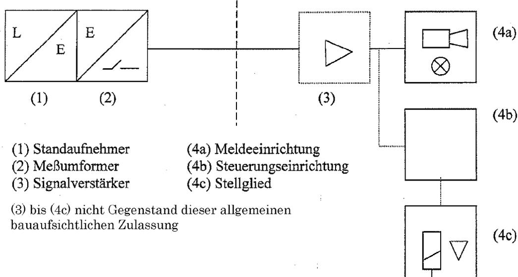
Standaufnehmer (Radar-Antenne) mit angebautem Messumformer vom Typ "RTG 3 ..." als
