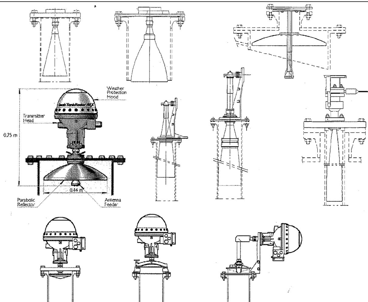
**Schema der Überfüllsicherung**
