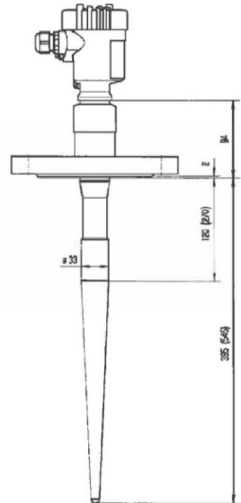
**Schema der Überfüllsicherung**
