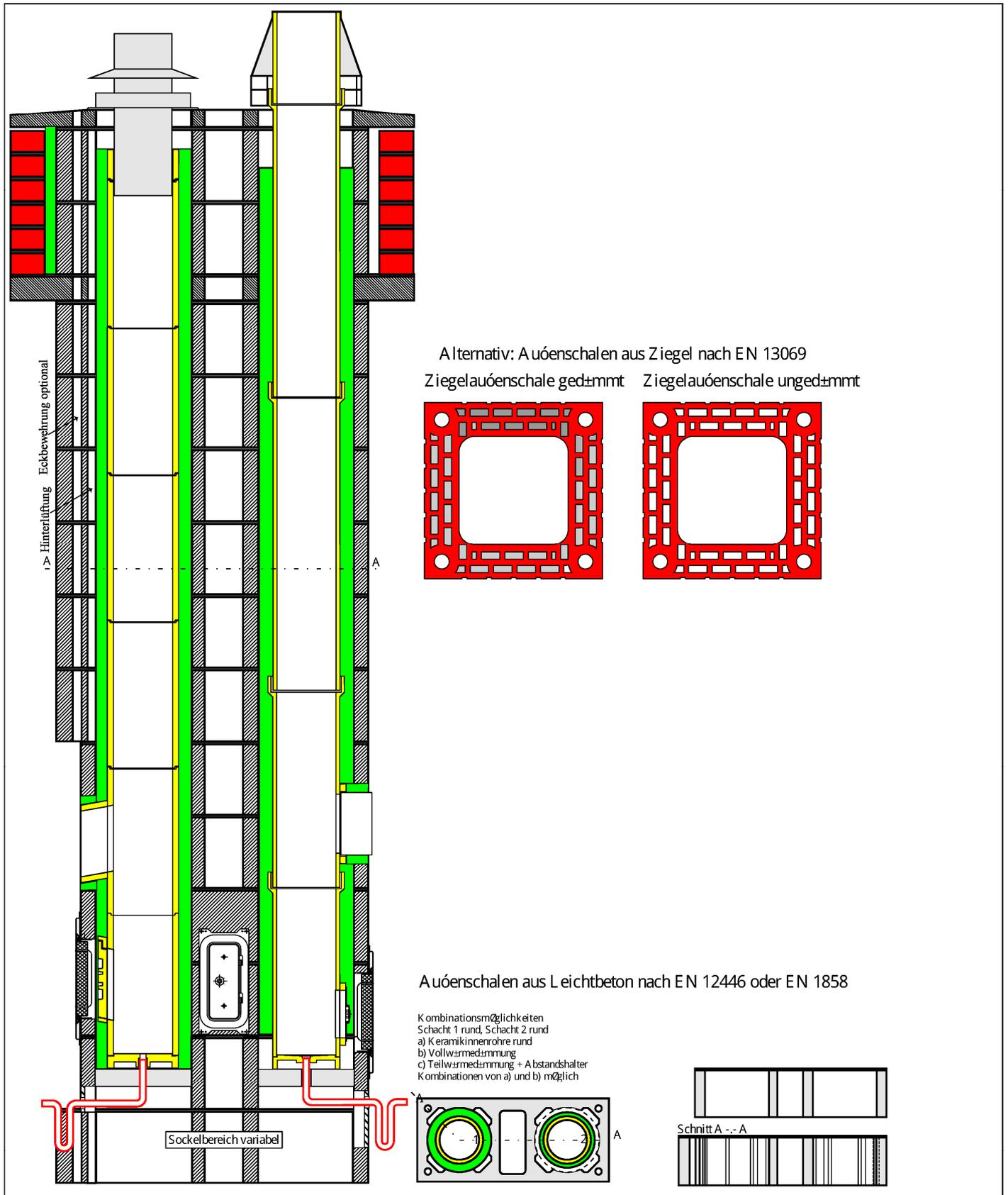
Bauarten für Bausätze aus Einzelteilen zur bauseitigen Montage von Abgasanlagen
