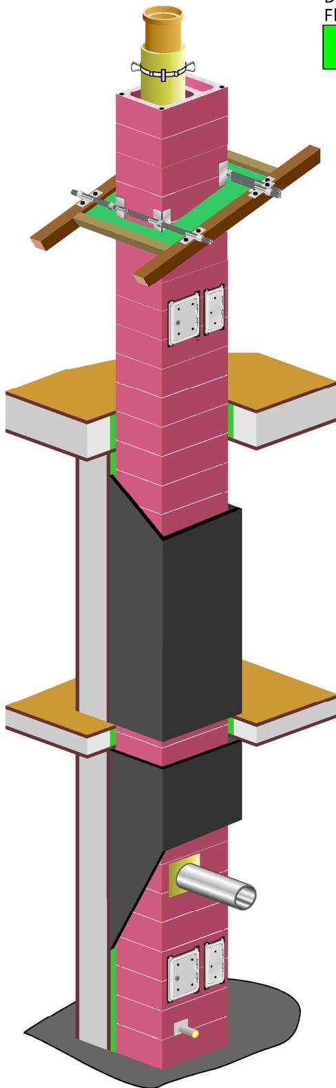
Dämmung im Decken- und Flachdachbereich
