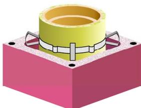
**PA 04: Abgasanlage - T400 N1 D 3 G50 (LA90)**
