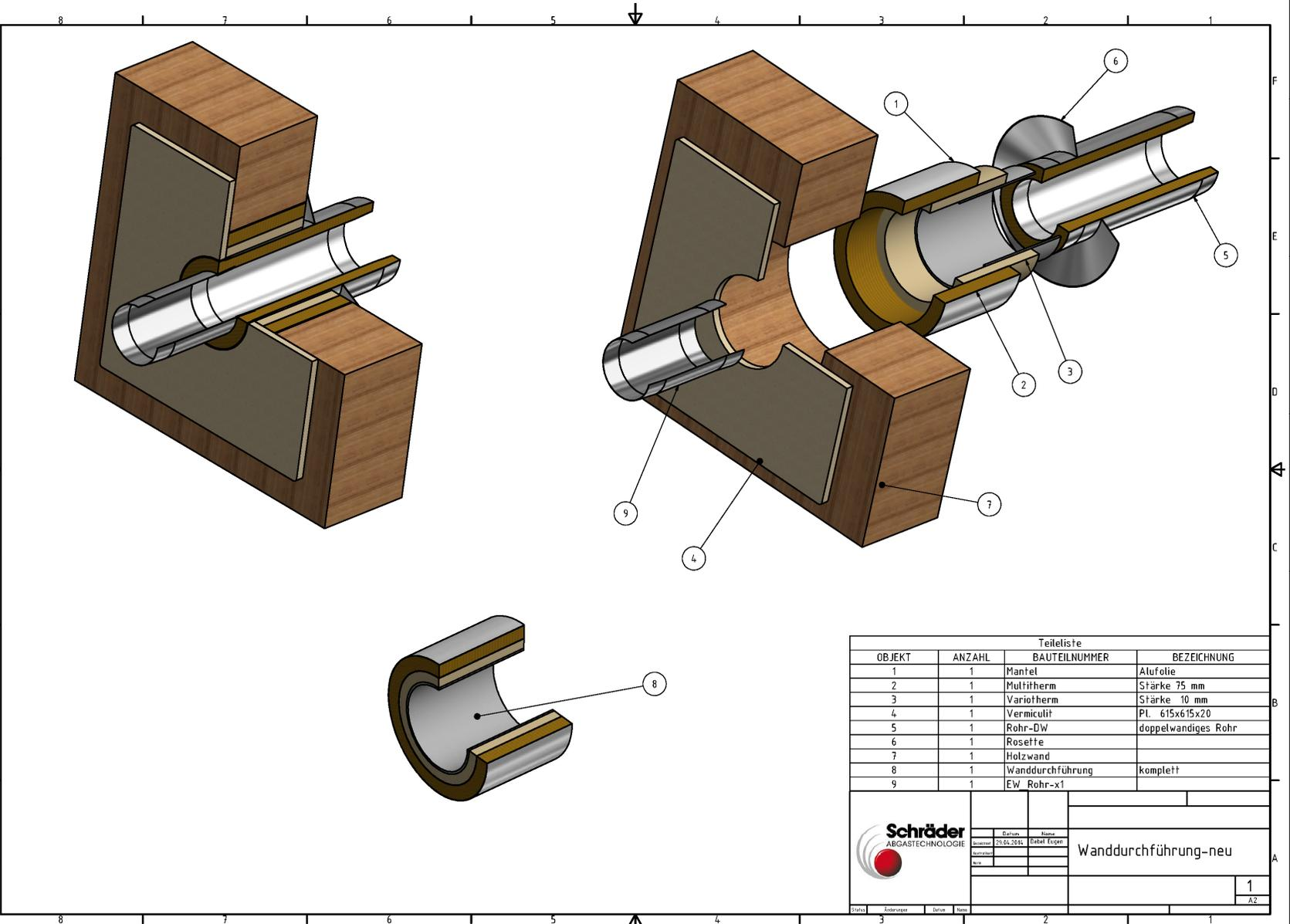
Bauelemente zur Herstellung von Wand-, Decken- und Dachdurchführungen von Schornsteinen, Abgasleitungen und Verbindungsstückten
