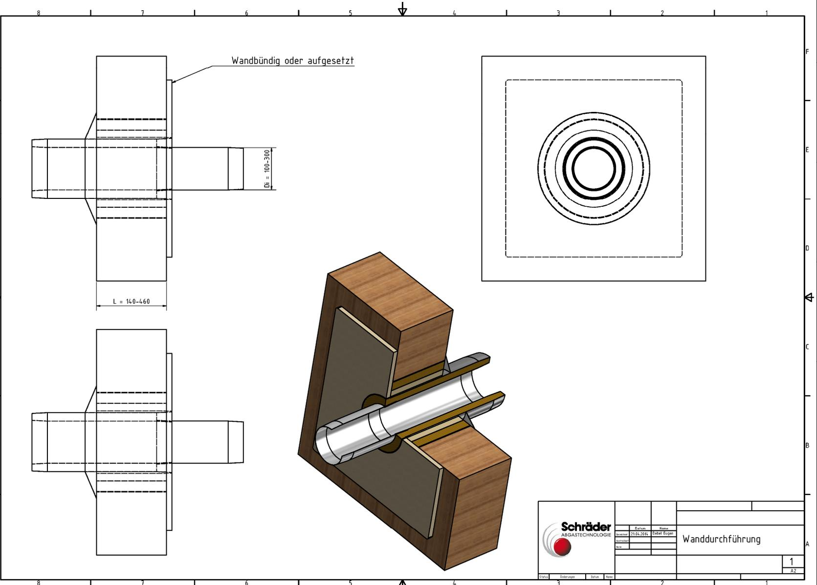
Bauelemente zur Herstellung von Wand-, Decken- und Dachdurchführungen von Schornsteinen, Abgasleitungen und Verbindungsstücken
