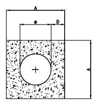
Die Formstücke können mit Nut- und Federprofil ausgestattet sein. Die Mindestwandstärke ist einzuhalten.
