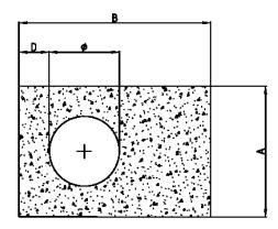
Die Formstücke können mit Nut- und Federprofil ausgestattet sein. Die Mindestwandstärke ist einzuhalten.
