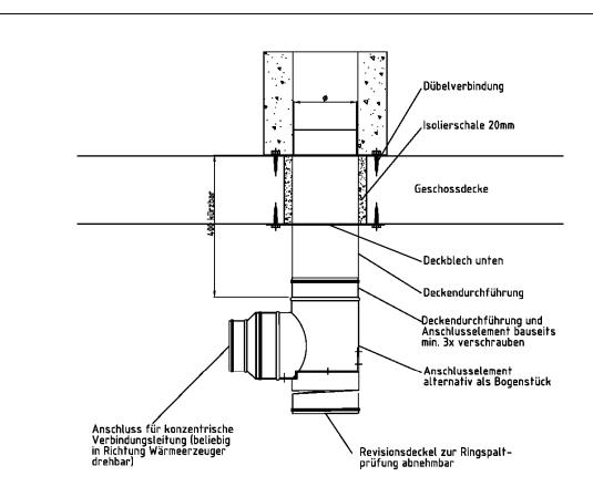
Deckendurchführung mit Anschlusselement für Schachtformstein bis  $\phi$  210 mm
