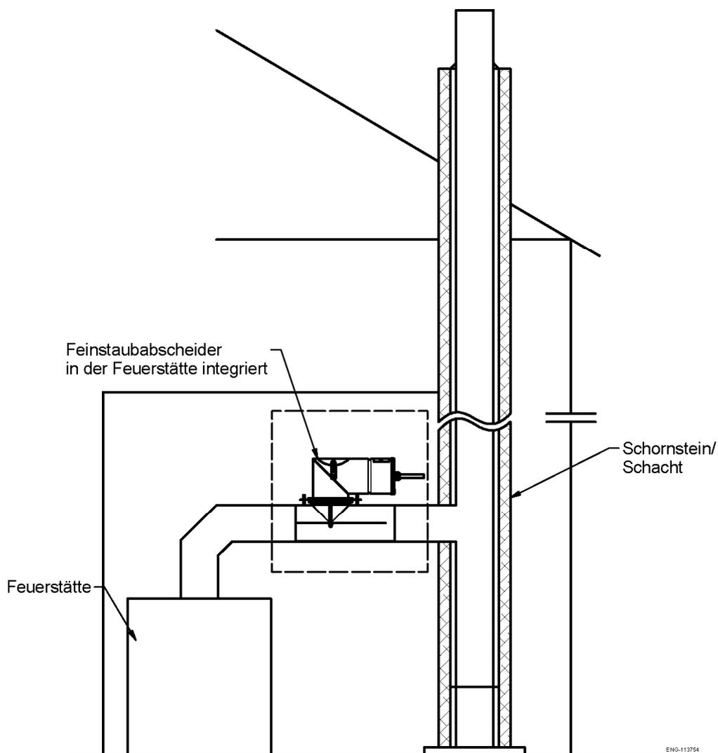
Staubabscheider Typ "AIRJEKT 1" und "AIRJEKT 1 Version 2.0" für Abgasanlagen
