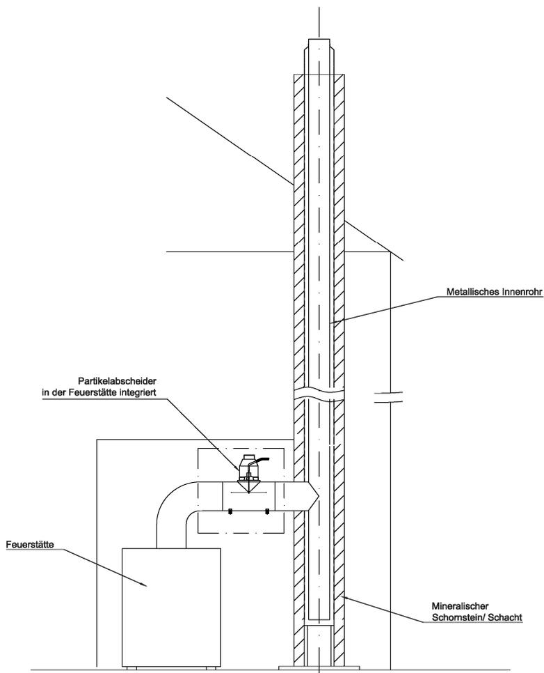
Staubabscheider Typ "AIRJEKT 1" und "AIRJEKT 1 Version 2.0" für Abgasanlagen
