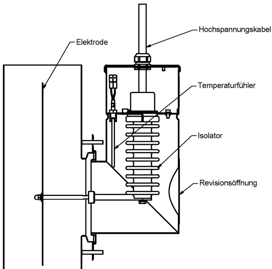
Staubabscheider Typ "AIRJEKT 1" und "AIRJEKT 1 Version 2.0" für Abgasanlagen
