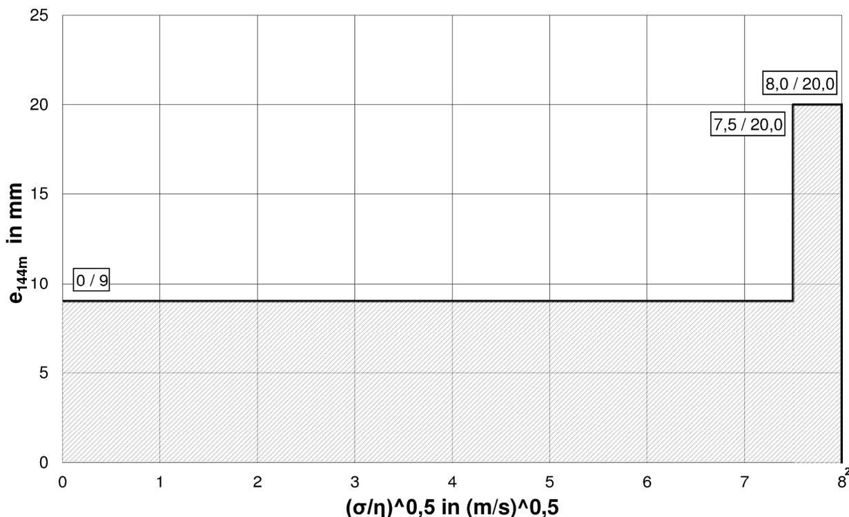
**Abbildung 1:** Eindringverhalten (mittlere Eindringtiefe  $e_{144m}$  von nicht betonangreifenden Flüssigkeiten)<sup>1,3</sup>, aufgrund der jeweiligen dynamischen Viskosität  $\eta$  und Oberflächenspannung  $\sigma$
