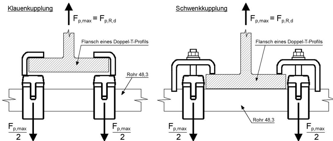
**Bild 3:** Verwendung von Klauen- und Schwenkkupplungen
