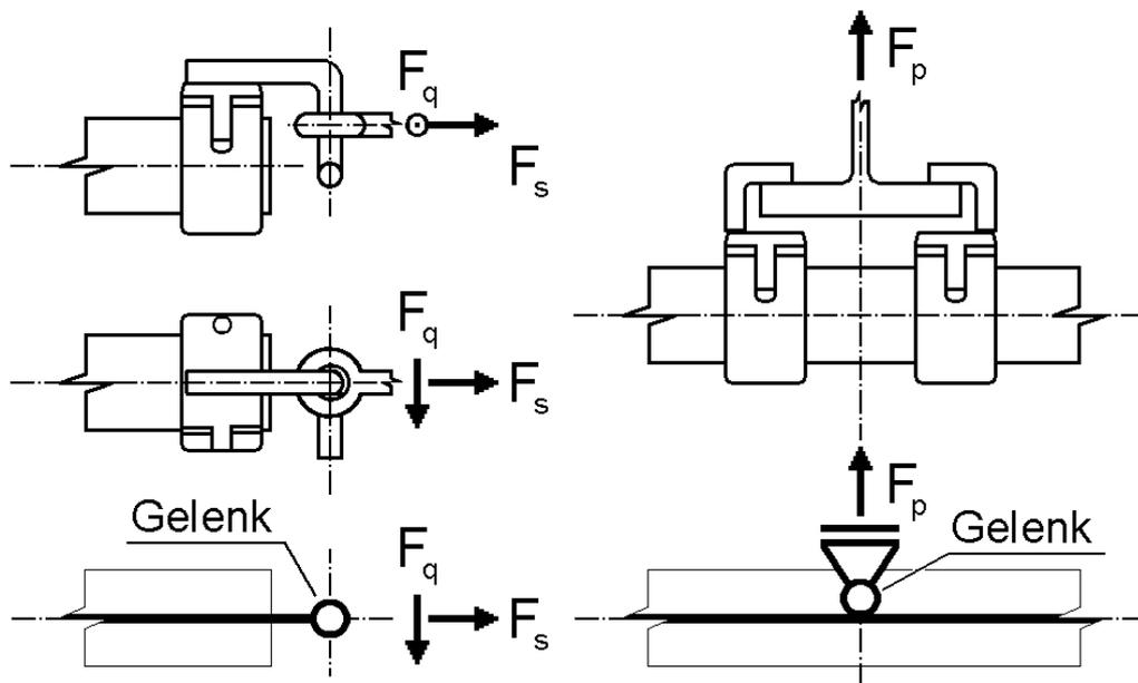
**Bilder 1a und 1b:** Statische Systeme der verschiedenen Anschlussvarianten
