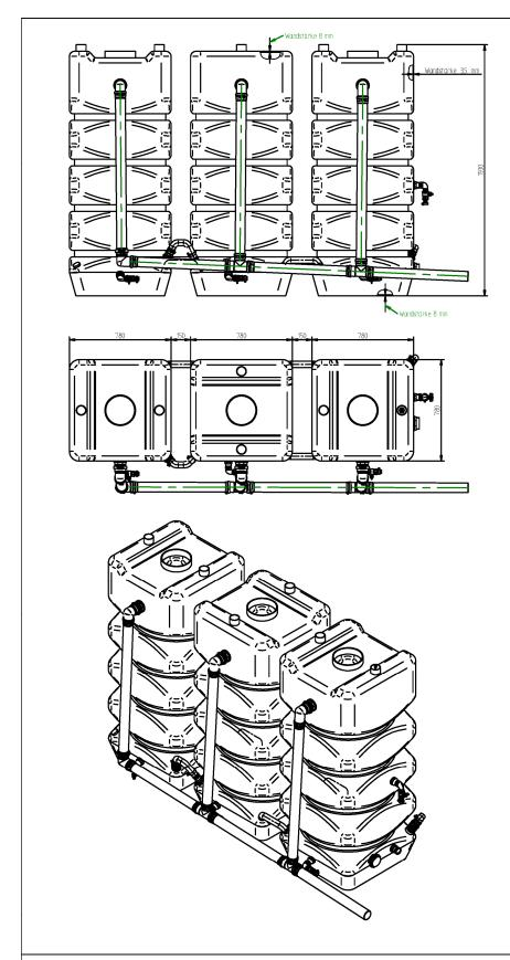
Anlage zur Behandlung von Abwässern aus der maschinellen Fahrzeugreinigung mit weitestgehender Kreislaufführung
