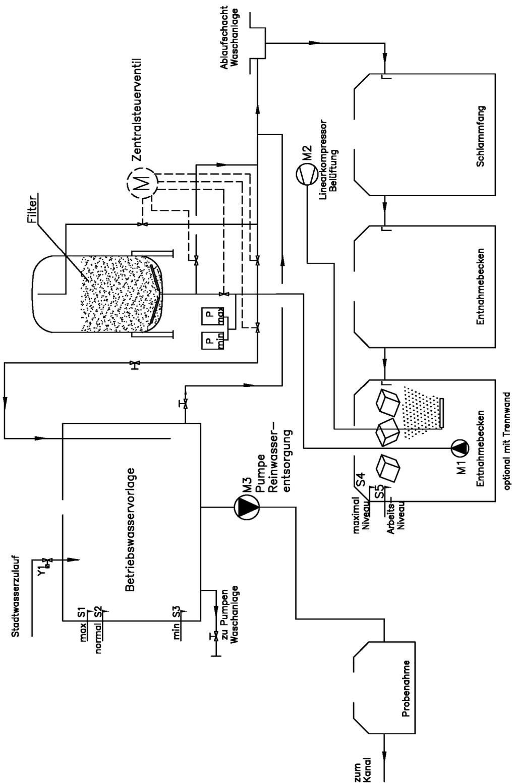
Anlage zur Behandlung von Abwässern aus der maschinellen Fahrzeugreinigung von PKW mit weitestgehender Kreislaufführung; Hacofresh 5
