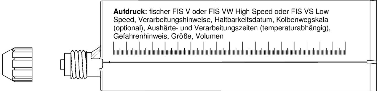
**Injektionskartusche (Koaxialkartusche) mit Verschlusskappe; Größen: 100 ml, 150 ml, 300 ml, 380 ml, 400 ml, 410 ml**
