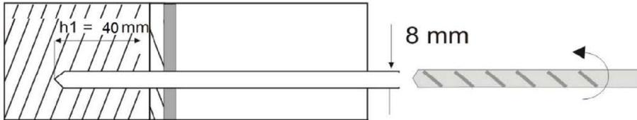
Bohrloch senkrecht zur Oberfläche des Untergrundes erstellen.
