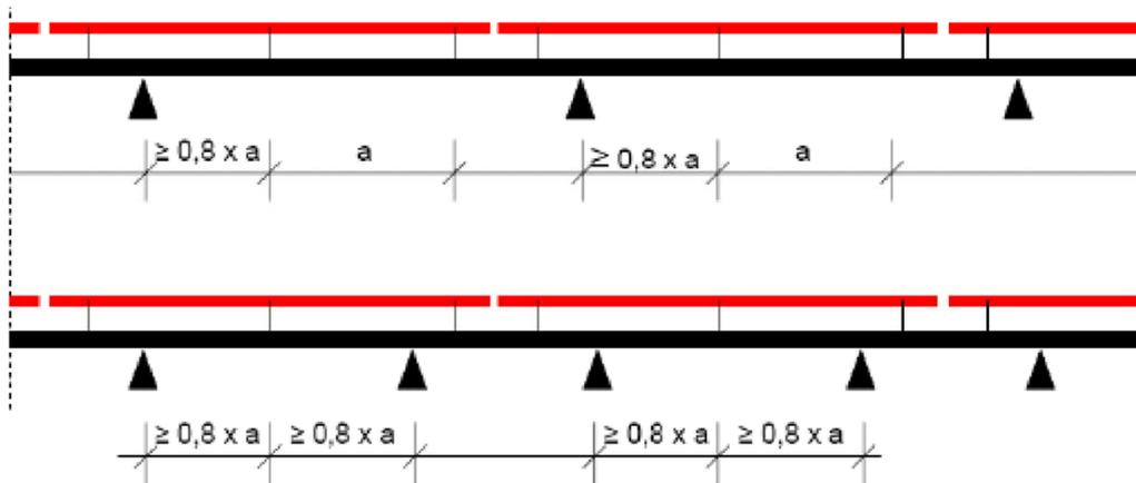
**Bild 6:** Bei Schienen, auf denen sich 3 Befestigungspunkte einer Platte befinden, müssen die mittleren Befestigungspunkte mindestens einen Abstand von  $0,8 \times a$  ( $a$  = Abstand zwischen den Befestigungspunkten der Platte) von den Auflagern haben.
