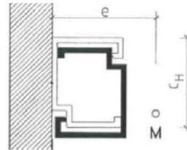
$e$  = Abstand zwischen Rückseite Fassadenplatte und Schubmittelpunkt des Horizontalprofils (s. Bild 1)
