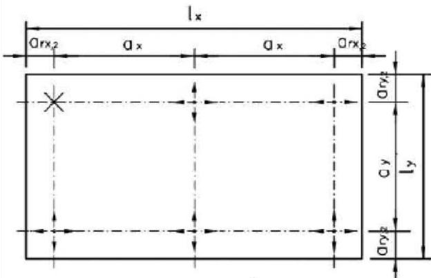
Bild 4: Fassadenplatte mit 6 Agraffen – Lagerungsart 3
