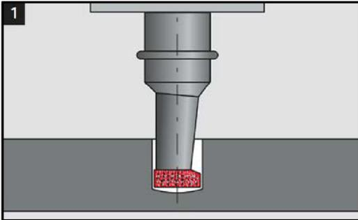
b) hinterschneiden und reinigen
