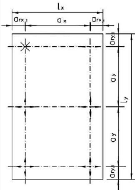
Bild 3: Fassadenplatte mit 6 Agraffen – Lagerungsart 2
