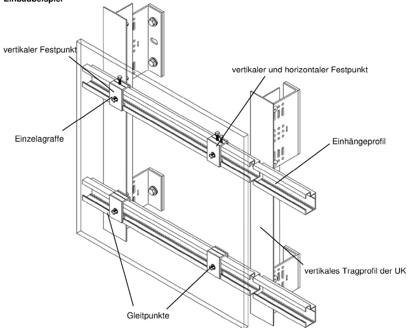
KEIL Hinterschnittanker KH
