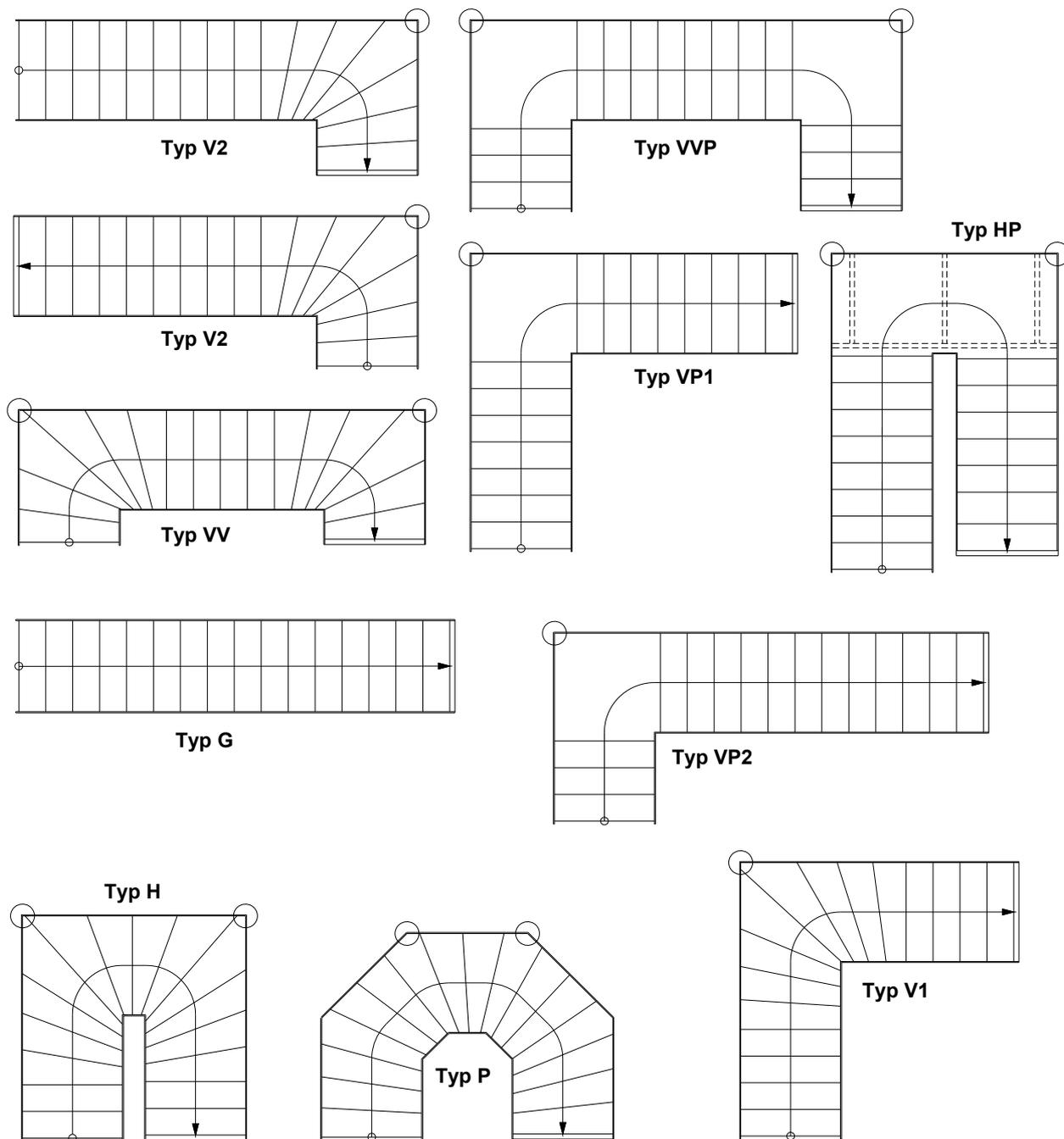
○ Auflager für Vertikallasten, horizontale Wandanbindung entsprechend technischer Dokumentation
