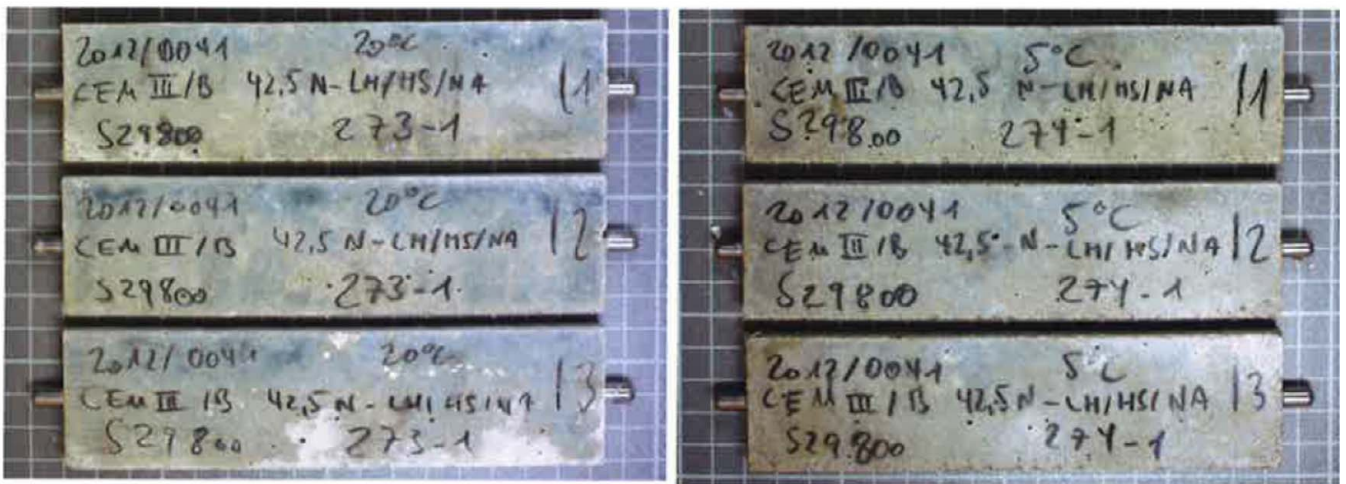
Bild A4: Flachprismen aus Hochofenzement CEM III/B 42,5 N-LH/SR nach 180 Tagen Lagerung in Na 2 SO 4 -Lösung bei 20 °C (links) und 5 °C (rechts)
