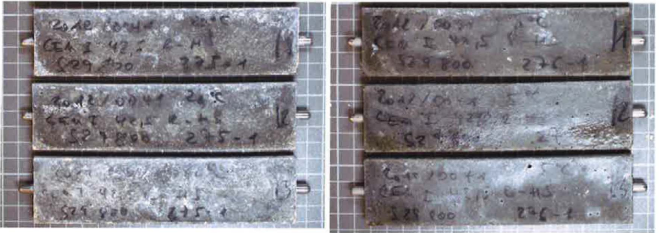
Bild A5: Flachprismen aus Portlandzement CEM I 42,5 R-SR0 nach 180 Tagen Lagerung in Na 2 SO 4 -Lösung bei 20 °C (links) und 5 °C (rechts)
