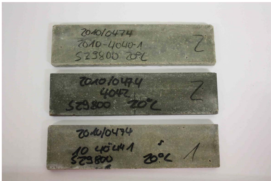
Bild A1: Flachprismen nach 180 Tagen Lagerung in Na 2 SO 4 -Lösung bei 20 °C Oben: Prisma aus CEM III/A 42,5 N-LH/SR/LA "Deuna" (Z1) mit Hüttensand 1 (S1); Mitte: CEM I 42,5 N-SR0; Unten: CEM III/B 42,5 N-LH-SR
