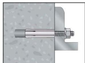
5. Bauteil befestigen, dabei das maximale  $T_{inst}$  nicht überschreiten.
