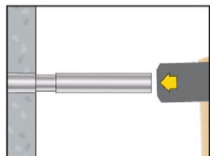
4. Mit dem Setzwerkzeug den Anker spreizen. Der Anker ist richtig verspreizt, wenn das Setzwerkzeug am Anker aufliegt.
