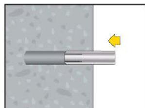
3. Anker von Hand bzw. durch Hammerschläge ins Bohrloch einbringen. Anker sollte bündig mit der Betonaußenkante sitzen.
