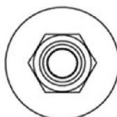
11. Ausführung mit Innengewinde und Sechskantantrieb z.B. TAPCON 6x55 IM M8/10
