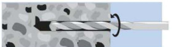
1. **Bohrloch** mit Hammerbohrer oder Hohlbohrer herstellen
