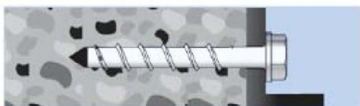
4. Der Schraubenkopf muss auf dem Anbauteil aufliegen und darf nicht beschädigt sein
