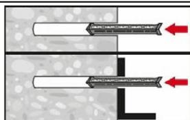
Die Mörtelpatrone mit der Spitze voraus bis zum Bohrlochtieftsten einschieben
