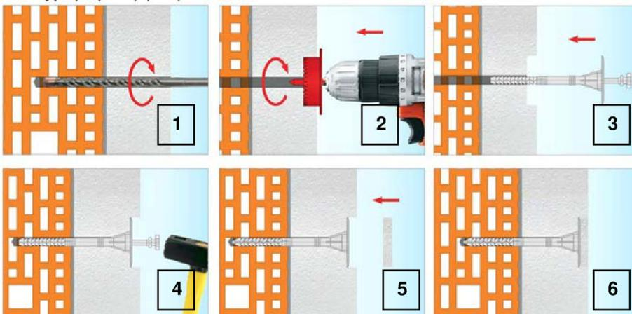
1) Bohrloch senkrecht zur Oberfläche erstellen. Reinigung des Bohrlochs.
