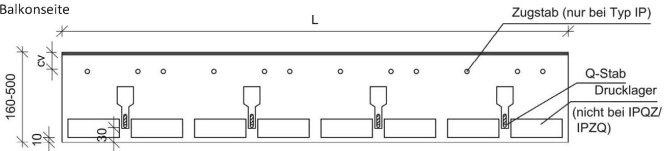
Plattenanschluss ISOPRO IP und ISOMAXX IM
