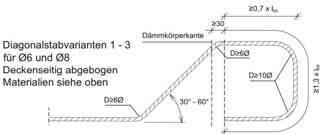
Plattenanschluss ISOPRO IP und ISOMAXX IM
