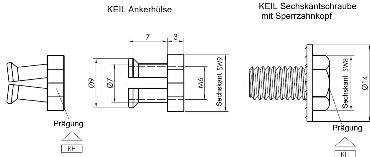
**Corian Fassadenplatten** (Maße in mm)
