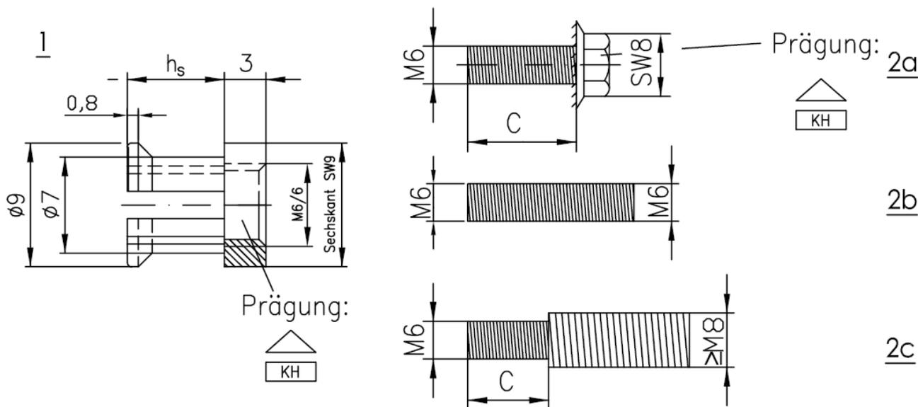
c: die Schraubenlänge ist auf die jeweilige Unterkonstruktion und Setztiefe des Ankers abzustimmen
