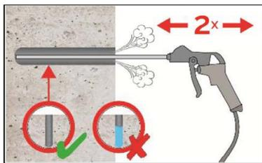
**2a.** Das Bohrloch vom Bohrlochgrund her 2x vollständig mit Druckluft (min. 6 bar) (Anhang B 4) ausblasen, bis die ausströmende Luft staubfrei ist. Bei tiefen Bohrlochern sind Verlängerungen zu verwenden.
