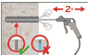
**2c.** Abschließend das Bohrloch erneut vom Bohrlochgrund her 2x vollständig mit Druckluft (min. 6 bar) (Anhang B 4) ausblasen, bis die ausströmende Luft staubfrei ist. Bei tiefen Bohrlochern sind Verlängerungen zu verwenden.
