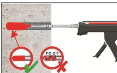
6. Gereinigtes Bohrloch vom Bohrlochgrund her ca. zu 2/3 mit Verbundmörtel befüllen. Langsames Zurückziehen des Statikmischers aus dem Bohrloch verhindert die Bildung von Luftpöckeln. Wird der Bohrlochgrund nicht erreicht, muss eine passende Mischerverlängerung verwendet werden. Die temperaturrelevanten Verarbeitungszeiten (Tabelle B5) sind zu beachten.
