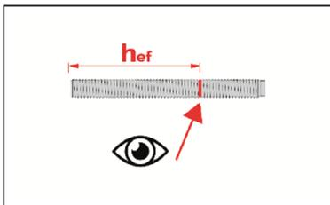
4. Vor dem Einstecken der Ankerstange in das gefüllte Bohrloch die geforderte Setztiefe auf der Ankerstange markieren.
