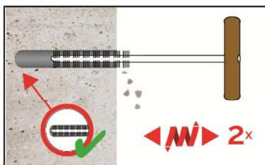
**2b.** Bürstendurchmesser prüfen (Tabelle B4). Das Bohrloch ist mit geeigneter Drahtbürste  $> d_{b,min}$  (Tabelle B4) minimum 2x mit Drehbewegungen auszubürsten. Wird der Bohrlochgrund mit der Bürste nicht erreicht, muss eine Bürstenverlängerung verwendet werden.
