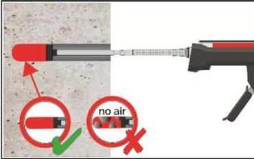
8. Den Verfüllstutzen bis zum Bohrlochgrund einführen und den Mörtel injizieren. Wird der Bohrlochgrund nicht erreicht, muss eine passende Mischerverlängerung verwendet werden. Während des Initiierens wird der Verfüllstutzen durch den Staudruck des Mörtels auf natürliche Weise aus dem Bohrloch gedrückt. Die temperaturrelevanten Verarbeitungszeiten (Tabelle B5) sind zu beachten.
