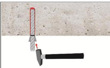
11. Bei Überkopfmontage ist die Ankerstange bis zum Start der Aushärtung zu fixieren (z.B. Holzkeile).
