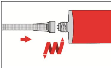
3. Den mitgelieferten Statikmischer fest auf die Kartusche aufschrauben und Kartusche in eine geeignete Auspresspistole einlegen. Bei jeder Arbeitsunterbrechung länger als die maximale Verarbeitungszeit (Tabelle B5) und bei jeder neuen Kartusche ist der Statikmischer zu erneuern.
