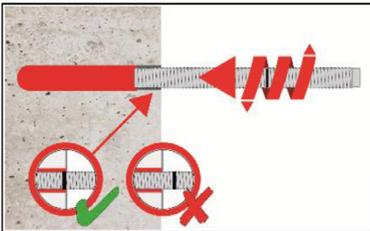
9. Befestigungselement mit leichten Drehbewegungen bis zur festgelegten Setztiefe einführen. Die Ankerstange muss frei von Schmutz-, Fett, Öl und anderen Fremdmaterialien sein.
