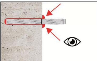
10. Nach der Installation des Ankers muss der Ringspalt zwischen Ankerstange und Beton, bei Durchsteckmontage zusätzlich auch Anbauteil, komplett mit Mörtel ausgefüllt sein. Tritt keine Masse nach Erreichen der Verankerungstiefe heraus, ist diese Voraussetzung nicht erfüllt und die Anwendung muss vor Beendigung der Verarbeitungszeit wiederholt werden.
