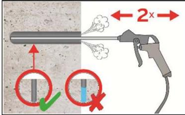
2f. Abschließend das Bohrloch erneut vom Bohrlochgrund her 2x vollständig mit Druckluft (min. 6 bar) (Anhang B 4) ausblasen, bis die ausströmende Luft staubfrei ist. Bei tiefen Bohrlöchern sind Verlängerungen zu verwenden.
